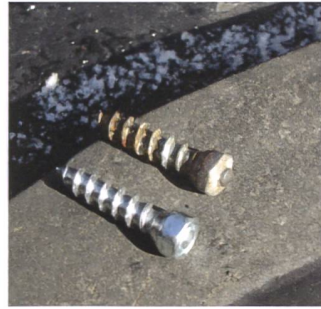
Nach 500 Betriebsstunden ist am Hartmetallstift kaum Verschleiss zu sehen.
