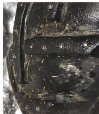
Einzelne Spikes sind in der weichen Gummimischung eingesunken.
