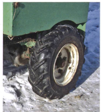
Beim engen Radkasten des Futterwagens wäre die Montage von Schneeketten nicht möglich.
