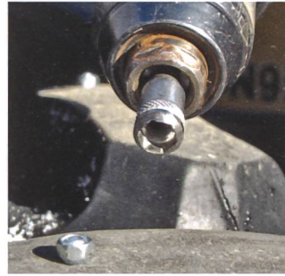
Dank konischer Form dringt der Schraubeinsatz gut in den Gummi ein.
