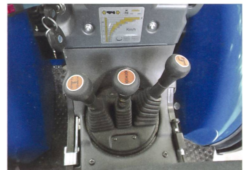
Konsole mit den Schalthebeln: Beim Wenden der Fahrerposition um 180° ist die Bedienung von Gruppen-Gangschaltung spiegelverkehrt. Die Bedienung der Wendeschaltung bleibt unverändert.
