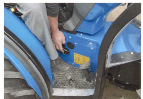
Die Bedienung des Handgriffs für die Feststellbremse funktioniert in Kombination mit der Betätigung der Fussbremse.
