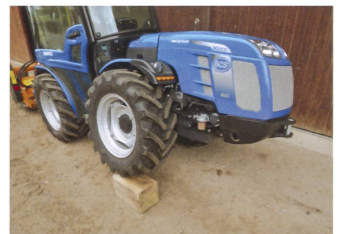
Durch das «OS-Frame Rahmensystem» kann sich der Traktor vor dem Zentralgelenk zusätzlich um 15° verdrehen.
