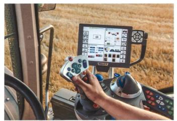
Die Menü-Einstellungen beim Varioterminal 10,4" erfolgen per Berührung des Bildschirms oder mit Navigationstasten. Zusätzlich ermöglicht ein Drehrad die effiziente Eingabe von Sollwerten. Bis zu vier Anwendungen lassen sich gleichzeitig darstellen. (Foto:
