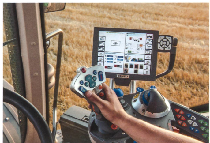
Die Menü-Einstellungen beim Varioterminal 10,4" erfolgen per Berührung des Bildschirms oder mit Navigationstasten. Zusätzlich ermöglicht ein Drehrad die effiziente Eingabe von Sollwerten. Bis zu vier Anwendungen lassen sich gleichzeitig darstellen. (Foto: AGCO GmbH)
