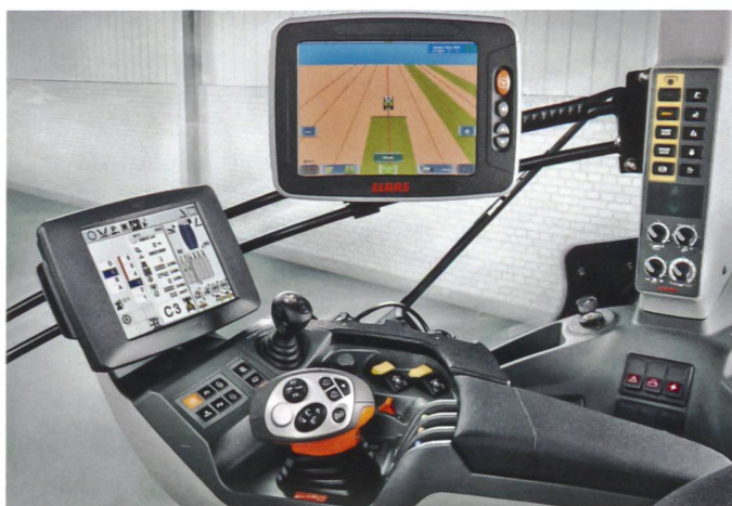
Das Neue Terminal S10 gehört zum Programm EASY (Efficient Agriculture Systems). Unter diesem Namen fasst Claas jetzt seine gesamte Elektronikkompetenz zusammen. Der Touchscreen zeigt wahlweise einzelne Anwendungsscreens bzw. das Einzelbild einer Kamera als Vollbild oder drei Screens verschiedener Anwendungen oder alle vier Kamerabilder gleichzeitig an. (Foto: CLAAS Agrosystems KGaA mbH & Co KG)
