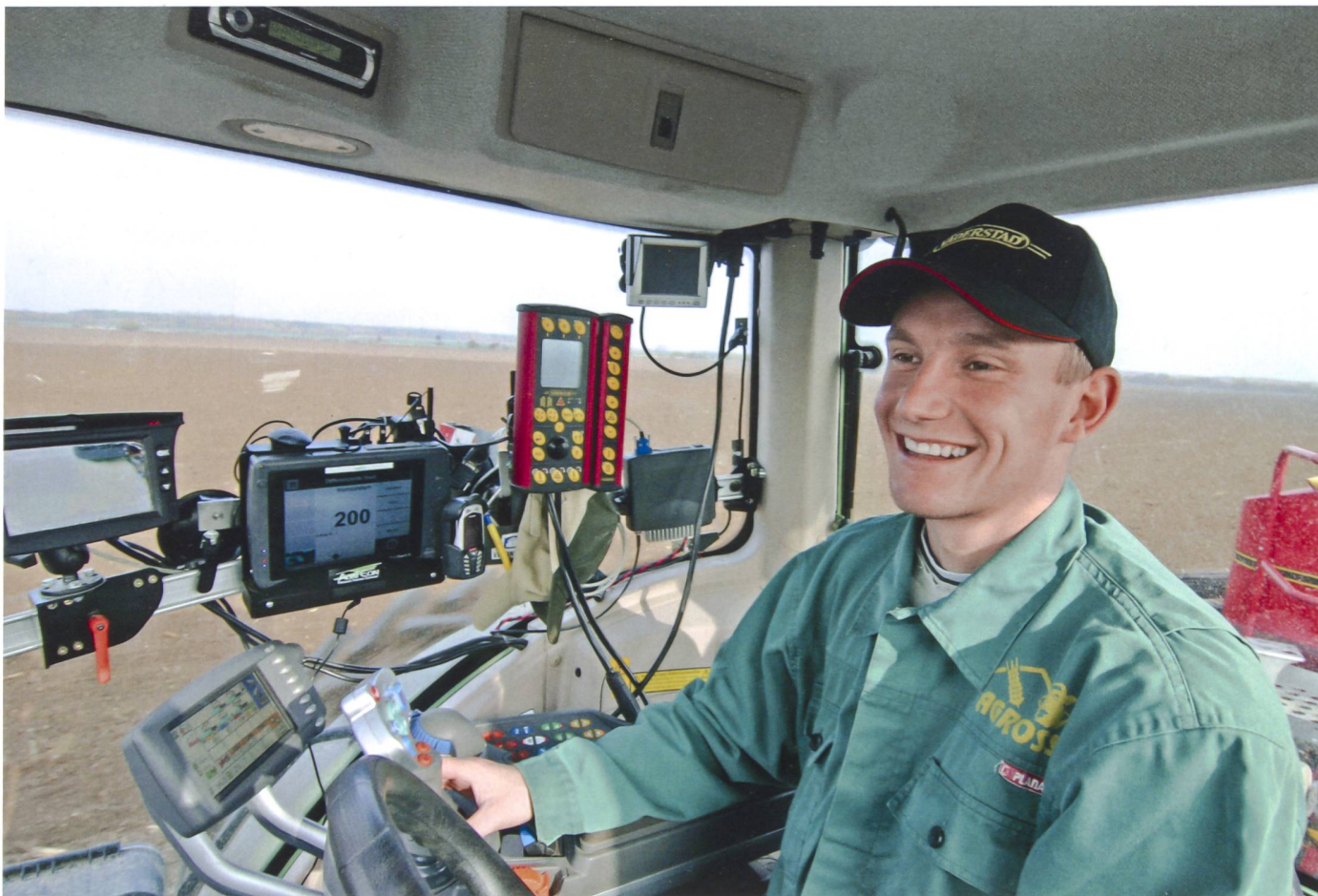
Für jede Funktion ein Terminal: Das war vor einigen Jahren noch unvermeidlich. Heute sieht es im Cockpit auch bei gleichzeitigem Einsatz verschiedener ISOBUS-Anwendungen mit einem oder zwei Bedienterminals schon wesentlich aufgeräumter aus. (Foto: Agro Con GmbH)
