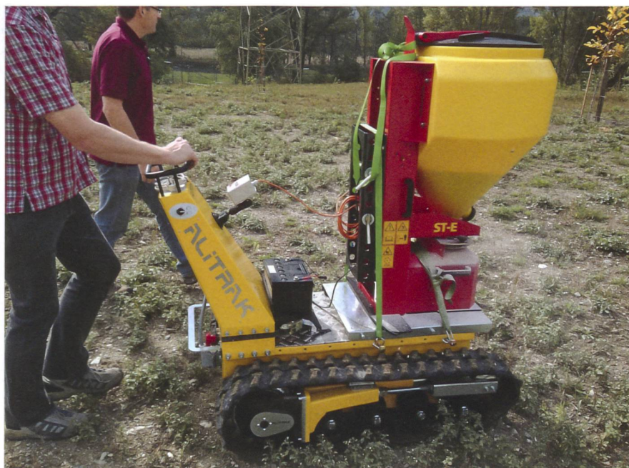
Der Düngerstreuer als Aufbau auf dem elektrischen Raupentraktor Alitrak ist eine praktische Einsatzvariante; hier reichen 5 bis 6 kW Leistung vollauf.
