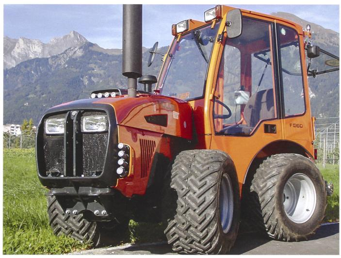
Gleich grosse Räder und eine optimale Gewichtsverteilung in Verbindung mit der richtigen Bereifung sorgen für eine effiziente Kraftübertragung. (Bild: Ruedi Hunger)
