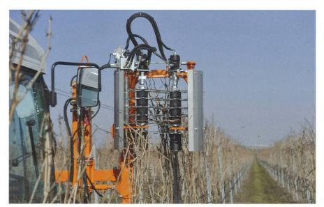
Viele Anbaugeräte sind wie dieser Vorschneider hydraulisch angetrieben, weshalb besondere Anforderungen an das Hydrauliksystem gestellt werden. (Werkbild)
