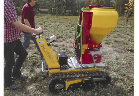
Der Düngerstreuer als Aufbau auf dem elektrischen Raupentraktor Alitrak ist eine praktische Einsatzvariante; hier reichen 5 bis 6 kW Leistung vollauf.
