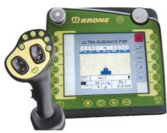
Das Umlegen von Steuerfunktionen auf den Multifunktionsgriff in der Traktorkabine oder einen separaten AUX-Joystick ist eine weitere Möglichkeit, die Eingabe per Taste und per Bildschirmberührung miteinander zu kombinieren. (Foto: Maschinenfabrik Bernard KRONE GmbH)
