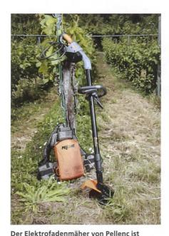
bereits erprobt; er erhält durch die hohe Kapazität der Ultra-Lithium-Rückenbatterie eine Autonomie von mindestens einem Arbeitstag.
