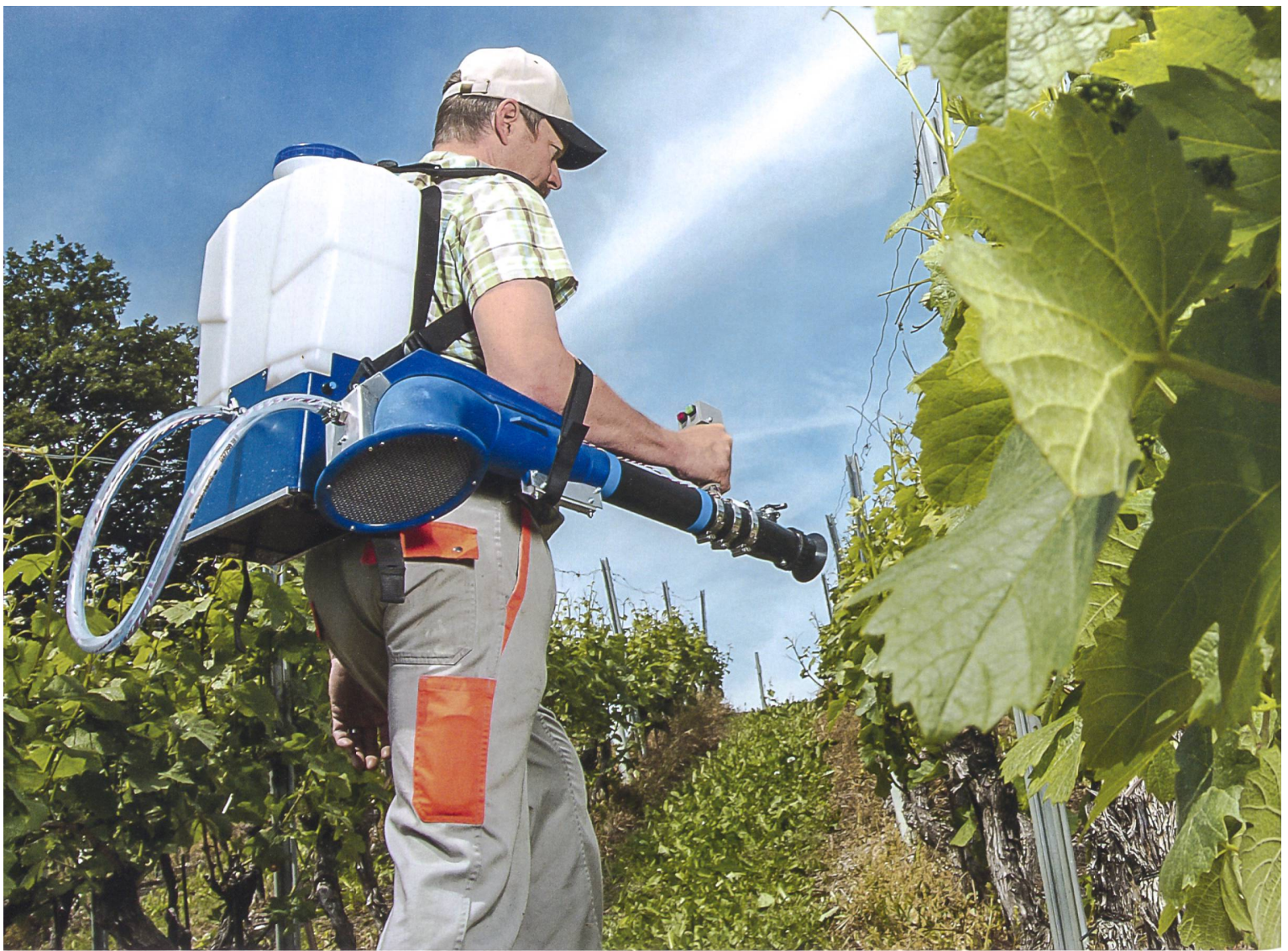
In Zusammenarbeit mit der Hochschule Wallis hat der Verein ValNaturePro in Salgesch diesen Prototyp einer elektrischen Rückenspritze geschaffen, welche gegenüber benzinbetriebenen Maschinen bei geringerer Lärmbelastung dasselbe Sprühergebnis liefert. (Bilder: Philippe Glenz, Bulle/Dominik Senn)
