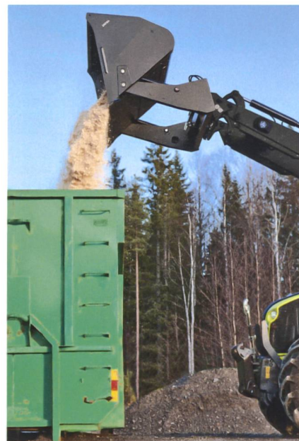
Die neuen Ålö-Hochkippschaufeln der Baureihe XH schaffen ca. 62 cm mehr Überladehöhe und ca. 40 cm Überladeweite. Die konische Bauweise erleichtert das Befüllen und Entleeren.
