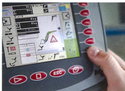
Auf dem Terminal können die Funktionen der Lade- und Wiegeautomatik übersichtlich dargestellt werden.
