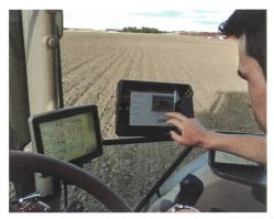
Zum neuen E-Service von Väderstad gehört eine Halterung fürs iPad, das dank App zum Bedienterminal für die Tempo-Sämaschine wird. So können die Funktionen nicht nur über das Touchscreen des iPads, sondern auch über Tasten gesteuert werden. (Foto:
