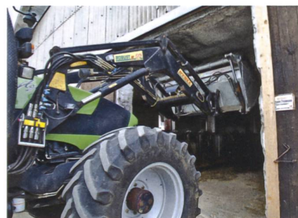
Die Isobus-Frontladersteuerung erlaubt es beispielsweise, in niedrigen Gebäuden die Hubhöhe zu begrenzen.
