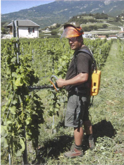
Die Batterie der elektrisch betriebenen Heckenschere hält mindestens einen Arbeitstag lang und diese wird von den Benutzern für ihre leichte Handhabung und geräuscharme Arbeitsweise geschätzt.
