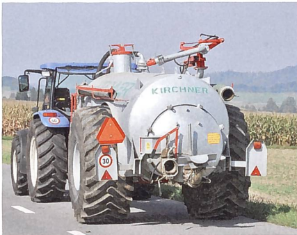
Auch Güllefässer müssen wegen der Gasgefahr vor dem Einstieg durchlüftet werden, das Öffnen des Doms genügt nicht!
