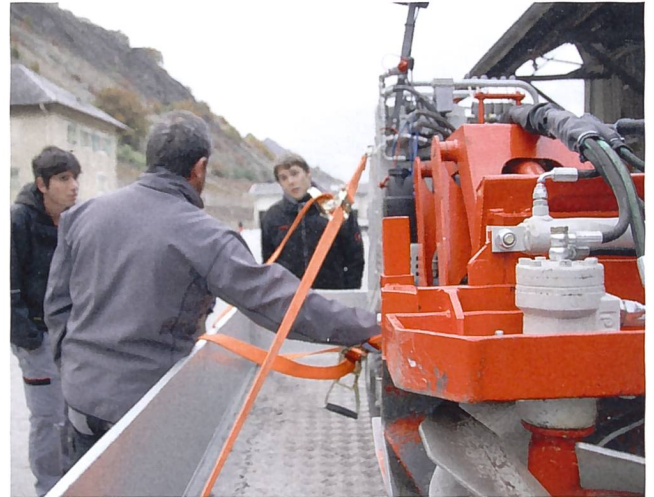
Beim Beschleunigen und Abbremsen entstehen grosse dynamische Kräfte. Grosse Bedeutung kommt deshalb der korrekten Ladungssicherung zu. Diese ist nicht immer leicht zu bewerkstelligen, je nachdem was transportiert wird und wenn geeignete Fixationspunkte fehlen.
