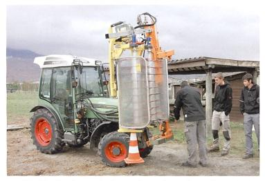
Matthieu Vergère vermittelt, wie ein sperriges Anbaugerät zweckmässig zu markieren ist, und kommt auf die gefährliche Gewichtsverlagerung zu sprechen, die den Schmalspurtraktor in Gefahr bringen kann, zum Beispiel bei der Kurvenfahrt und beim Geräteeinsatz.
