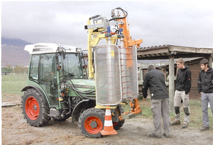
Matthieu Vergère vermittelt, wie ein sperriges Anbaugerät zweckmässig zu markieren ist, und kommt auf die gefährliche Gewichtsverlagerung zu sprechen, die den Schmalspurtraktor in Gefahr bringen kann, zum Beispiel bei der Kurvenfahrt und beim Geräteinsatz.
