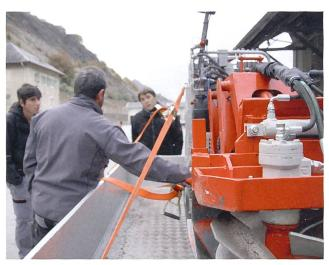
Beim Beschleunigen und Abbremsen entstehen grosse dynamische Kräfte. Grosse Bedeutung kommt deshalb der korrekten Ladungssicherung zu. Diese ist nicht immer leicht zu bewerkstelligen, je nachdem was transportiert wird und wenn geeignete Fixationspunkte fehlen.
