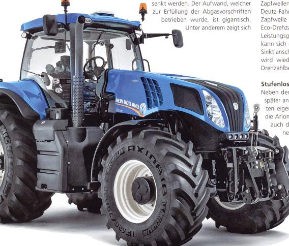
Laut New Holland bringt der 3550 mm grosse Radstand mehr Stabilität und Traktion. Letztere wird mit einem Traktionsmanagementsystem, das die 100%ige Umsetzung der Antriebsleistung in Zugkraft garantiert, zusätzlich optimiert.
