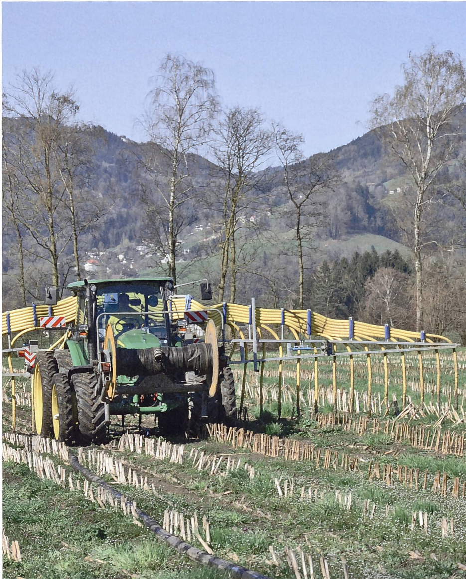
Bodenschutz steht im Vordergrund, daher fährt Josef Oeler konsequent mit Doppelbereifung. (Bilder: Ruedi Hunger)
