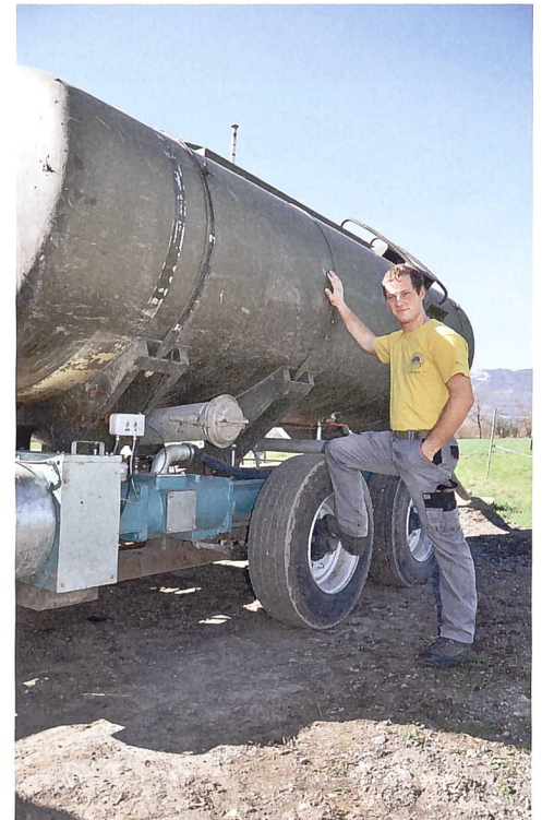
Mit dem aufgebauten Wassertank spült Josef Oeler am Schluss die ganze Leitung, damit immer saubere Schläuche aufgerollt werden.
