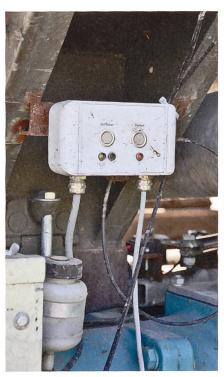
Empfangsstation auf dem Anhänger mit Pumpe. Hier kann bei Bedarf auch manuell bedient werden.
