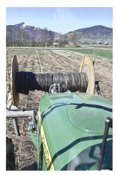
Auf zwei Schlauchhaspeltrommeln finden bis 1000 Meter Schlauch Platz und können nach Bedarf eingesetzt werden.
