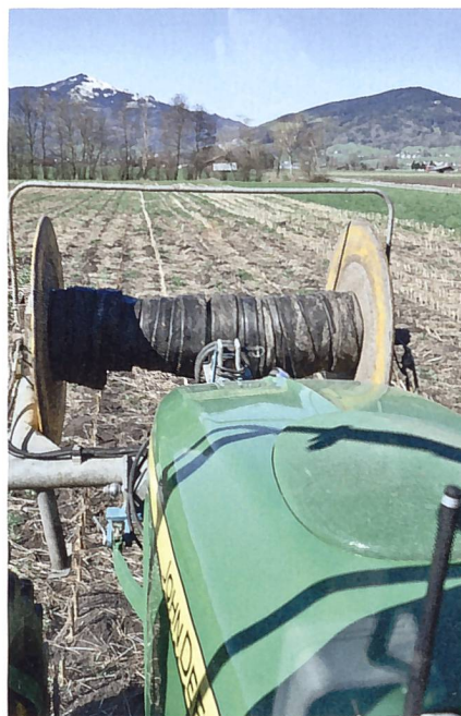
Auf zwei Schlauchhaspeltrommeln finden bis 1000 Meter Schlauch Platz und können nach Bedarf eingesetzt werden.
