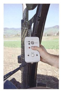
Mittels Funksteuerung wird die Pumpe einund ausgeschaltet und der Schieber am Wassertank bedient.
