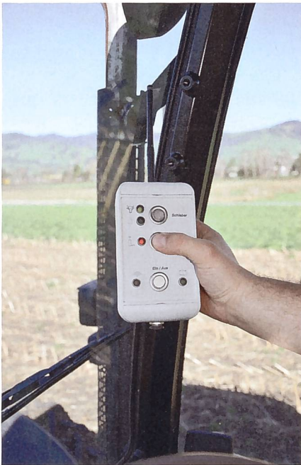
Mittels Funksteuerung wird die Pumpe ein- und ausgeschaltet und der Schieber am Wassertank bedient.
