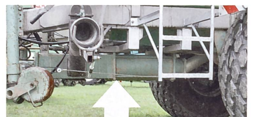
Exzentrerschneckenpumpen fördern längs zur Rotationsachse, sind deshalb schlank gebaut und beanspruchen auf einem Fass relativ wenig Platz (Bild rechts: Ruedi Hunger).
