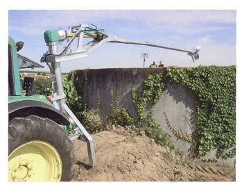
Selbst Hochbehälter sind heute kein Hindernis mehr für Zapfwellenrührwerke. Entweder wird die Höhe mit einem Turm oder mit langen klappbaren Elementen überwunden.
