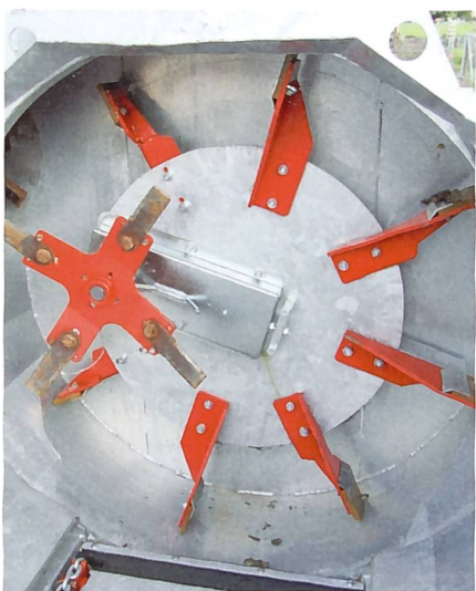
Der Sternrotor ist das charakteristische Bauteil eines Seitenstreuers. Das Abfräsen und Beschleunigen des Streugutes ist ein kräftezehrender Vorgang. (Bild: Ruedi Hunger)
