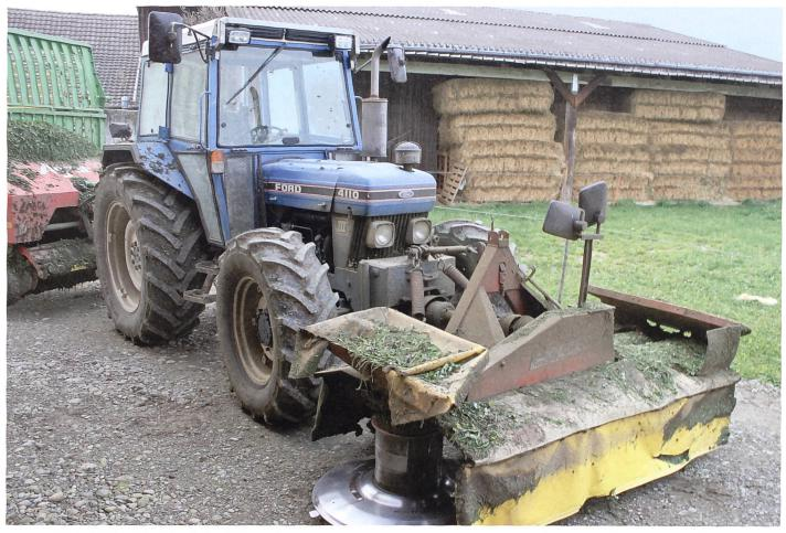
Diese Fahrzeugkombination eignet sich gut auf ebenen Parzellen. In Hanglagen wird die Kippgefahr aber durch den vorderen Überhang mit der damit verbundenen Veränderung der Schwerpunktlage wesentlich erhöht. Der Fahrer überlegt mit Vorteil vor Arbeitsbeginn, ob die nötige Kippsicherheit unter den gegebenen Umständen noch vorhanden ist. (Bilder: Ruedi Gnädinger)
