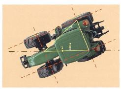
Gegenüber der reinen Schichtenlinienfahrt (braune strich-punktierte Linie) liegt bei einer Schrägfahrt nach unten der Schwerpunkt besonders nahe bei der Kippkante oder liegt bei einem kopflastigen Fahrzeug sogar über der Kippkante. Mit einem Unfall ist zu rechnen.
