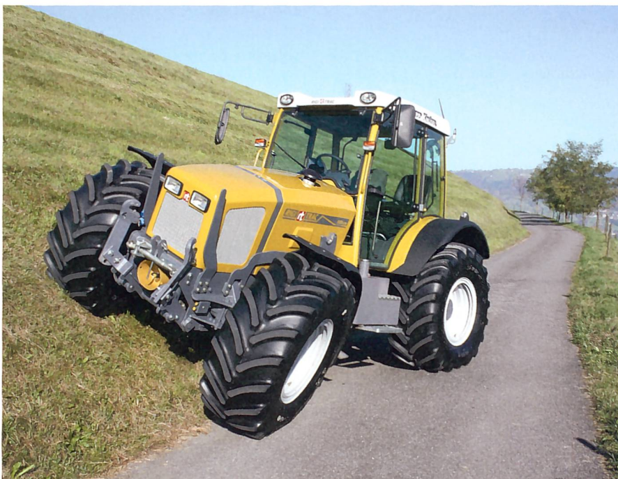
Nischenmarkt für besonders hangtaugliche Traktoren: Fronthydraulik wird von der Vorderachse getragen. Diese Bauart hat sich bei den Zweiachsmähern schon lange durchgesetzt und bewährt.
