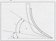
Das Einsatzziel des Grubbers bestimmt die Schargeometrie. Dabei beeinflusst der Schnittwinkel ( $\alpha$ ) vor allem die Mischwirkung, aber auch den Zugwiderstand der Zinken. Er ist bei der Schmaloder Herzschar an Universalgrubbern grösser als bei der Gänsefussschar, die insbesondere bei der mechanischen Unkrautbekämpfung eingesetzt wird. Keilwinkel ( $\beta$ ) und Freiwinkel ( $\gamma$ ) haben vorrangig Wirkung auf das Einzugsverhalten des Zinkengerätes.
