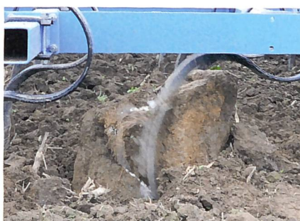
Szenen einer Begegnung: Federzinken trifft auf Feldstein. Beim Wegdrücken nach hinten und zur Seite sowie beim Vorschnellen muss der Zinken enorme Kräfte aufnehmen.
