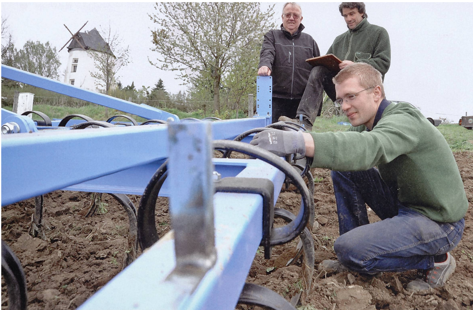
Vorbereitung für die nächste Grubber-Messfahrt im Rahmen des Dresdner Forschungsprojektes zur Entwicklung neuer Federzinken.
