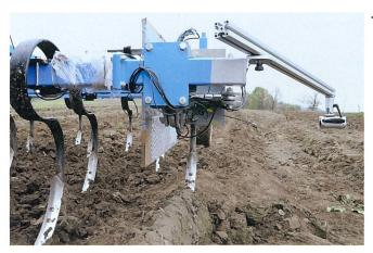
Messfühler und eine hochauflösende Kamera registrieren jede Krafteinwirkung und die Bewegung des Federzinkens bei der Fahrt über den Acker.
