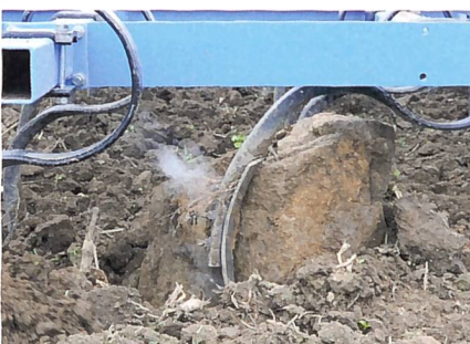
Szenen einer Begegnung: Federzinken trifft auf Feldstein. Beim Wegdrücken nach hinten und zur Seite sowie beim Vorschnellen muss der Zinken enorme Kräfte aufnehmen.
