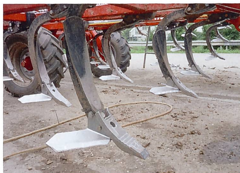
Mit Hartmetall beschichtete Flügel-schar an einem Grubber mit starren Zinken der Firma Horsch. (Foto: Werkbild Betek GmbH & Co. KG)
