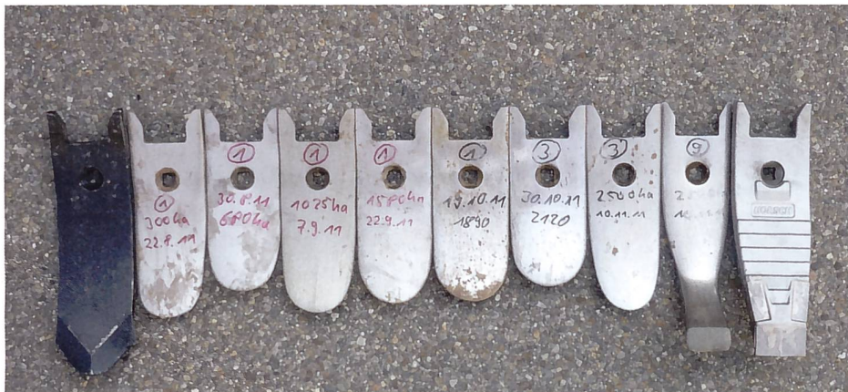
Schare unterliegen heute wegen der höheren Arbeitsgeschwindigkeit einem stärkeren Verschleiss. Hartmetallbestückung verlängert die Standzeit. Im Bild: Links eine normale Stahlschar und rechts eine Schar mit Hartmetallbeschichtung im unbenutzten Zustand. Die Hartmetallschar überstand an einem Grubber sieben Scharwechsel an den benachbarten Zinken. (Foto: Werkbild Betek GmbH & Co. KG)
