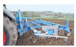
Sowohl an einem der Zinken des an der TU Dresden entwickelten Versuchs-Grubbers als auch an der Schnittstelle zwischen Gerät und Traktor registrieren Sensoren alle auftretenden Kräfte und Momente. Die Stützräder sitzen weit aussen, damit die Grubber-Wirkung gut zu sehen ist.
