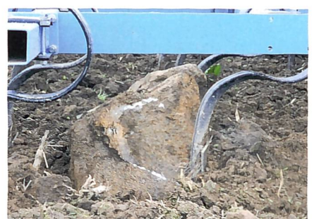
Szenen einer Begegnung: Federzinken trifft auf Feldstein. Beim Wegdrücken nach hinten und zur Seite sowie beim Vorschnellen muss der Zinken enorme Kräfte aufnehmen.
