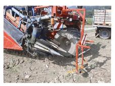
Der elektronisch gesteuerte Reihensucher, dahinter die gegenläufig drehenden Pellerbürsten und darunter das Rüttelschar.
