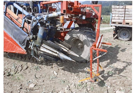
Der elektronisch gesteuerte Reihensucher, dahinter die gegenläufig drehenden Pellerbürsten und darunter das Rüttelschar.
