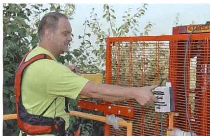
Der Steuerungskasten für die Hebebühne ist von der Traktorsteuerung getrennt.
