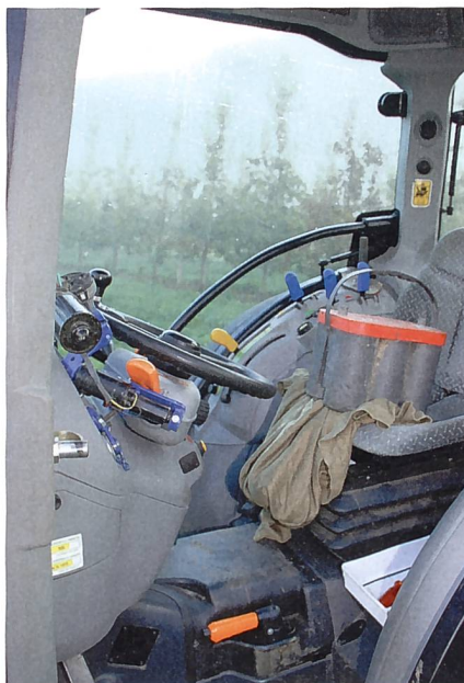
Die Fahr- und Lenkeinheit wird mit einem Handgriff unter dem Lenkrad eingelegt; den Fahrer simuliert eine Autobatterie.
