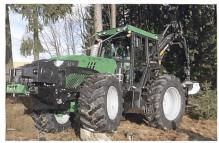
Das zweistufige Frontzapfwellengetriebe kann über Funk geschaltet werden. Dadurch ist es möglich, mit der Frontseilwinde bei niedriger Last entweder mit geringerer Motordrehzahl oder mit erhöhter Rückegeschwindigkeit zu arbeiten. Zur Feinjustierung lässt sich ebenfalls die Motordrehzahl fernsteuern. Wird die Frontzapfwelle nicht benötigt, schaltet eine Automatikfunktion nach drei Minuten den Motor aus.
