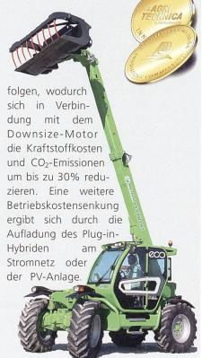
Der Lader erbringt vollelektrisch die Leistung eines regulären Teleskopladers der «Vier-Tonnen/Sieben-Meter»-Klasse. Bis zu zwei Stunden arbeitet er vollelektrisch, bis zu vier Stunden im sparsamen Eco-Modus.
