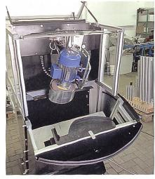
Der **«AQUA NON STOP COMFORT»** ist das erste Nassschleifgerät für Ladewagen- und Pressenschneidwerksmesser, das sich automatisch dem Messer an-
