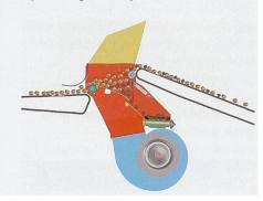
passt. Unabhängig vom Verschleisszustand der Messer werden diese nicht mehr nach fixen Radien, sondern exakt entlang ihrer individuellen Schneidenkontur geschliffen. Das Gerät bearbeitet bis zu 45 Messer pro Arbeitsgang. Durch die austauschbaren Schablonen können die unterschiedlichsten Messertypen exakt geschliffen werden.
