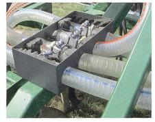
Bei der Einbringung von Gülle in den Boden ist unabhängig vom gewählten Einbringungswerkzeug die Überwachung und Kontrolle des Durchflusses in den Verteilschläuchen eine Herausforderung. Der neuartige **Sensor (FlowCheck)** überwacht akustisch den Durchfluss in jedem Verteilschlauch. Wird der Güllestrom unterbrochen, erhält der Fahrer ein
