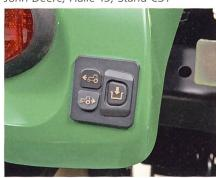
Der Traktor lässt sich dank der neuen Funktion «Hitch Assist» per Knopfdruck von ausserhalb der Kabine vor- und rückwärts bewegen. Damit können Geräte nicht nur leichter, sondern auch sicherer als bislang angekuppelt werden, denn besonders das unfallträchtige Auf- und Absteigen wird deutlich reduziert. Die Bedienung des Systems erfolgt bei angezogener Handbremse und ist damit auch am Hang möglich.
