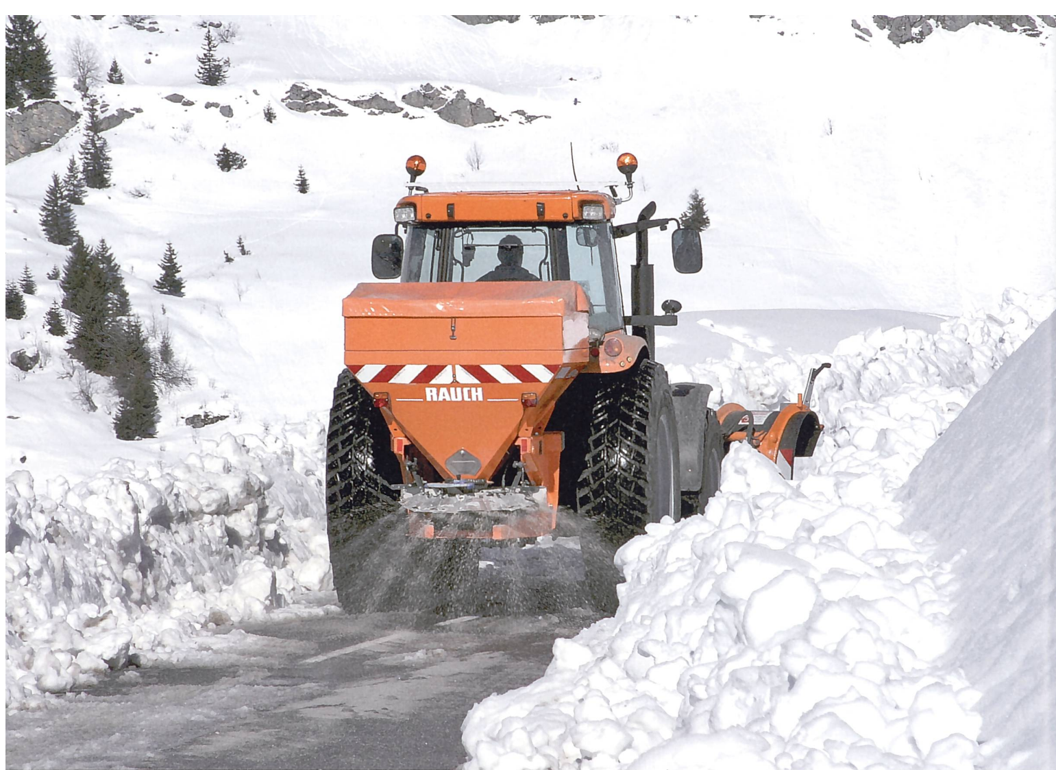
Angepasste Streuscheiben-Drehzahl, begrenzte Wurfweite, hydraulischer Antrieb und geschützte Elektronikkomponenten zeichnen einen modernen Winterdienststreuer aus. (Bilder: Firmenaufnahmen)
