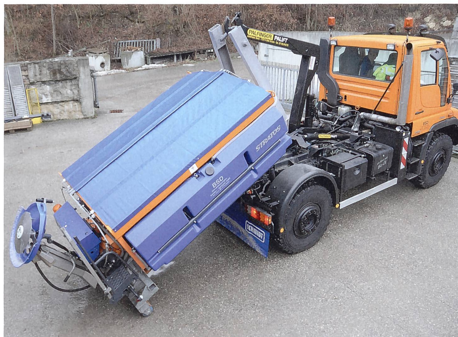
Ein Abrollgerät ermöglicht den minutenschnellen Wechsel von Aufbaugeräten und damit eine optimale Ausnutzung des Fahrzeuges auch ausserhalb des Winterdienstes.
