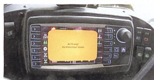
Das Anzeigedisplay mit Untermenüs ist praktisch gestaltet. Warnungen werden gross angezeigt (unten).
