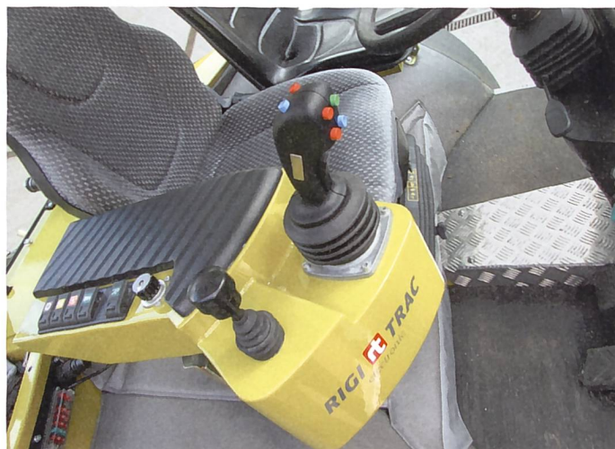
Joystick und Fahrhebel sind identisch mit den beiden grösseren Rigitrac-Modellen, jedoch gibt es keine EHR.
