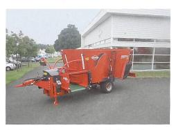
Der Futtermischwagen Profile 80 Compact verfügt über eine enge Spurweite.
