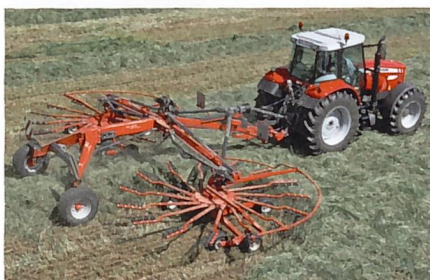
Der aufgesattelte Kreiselchwader mit mittiger Schwadablage: GA 9531.
