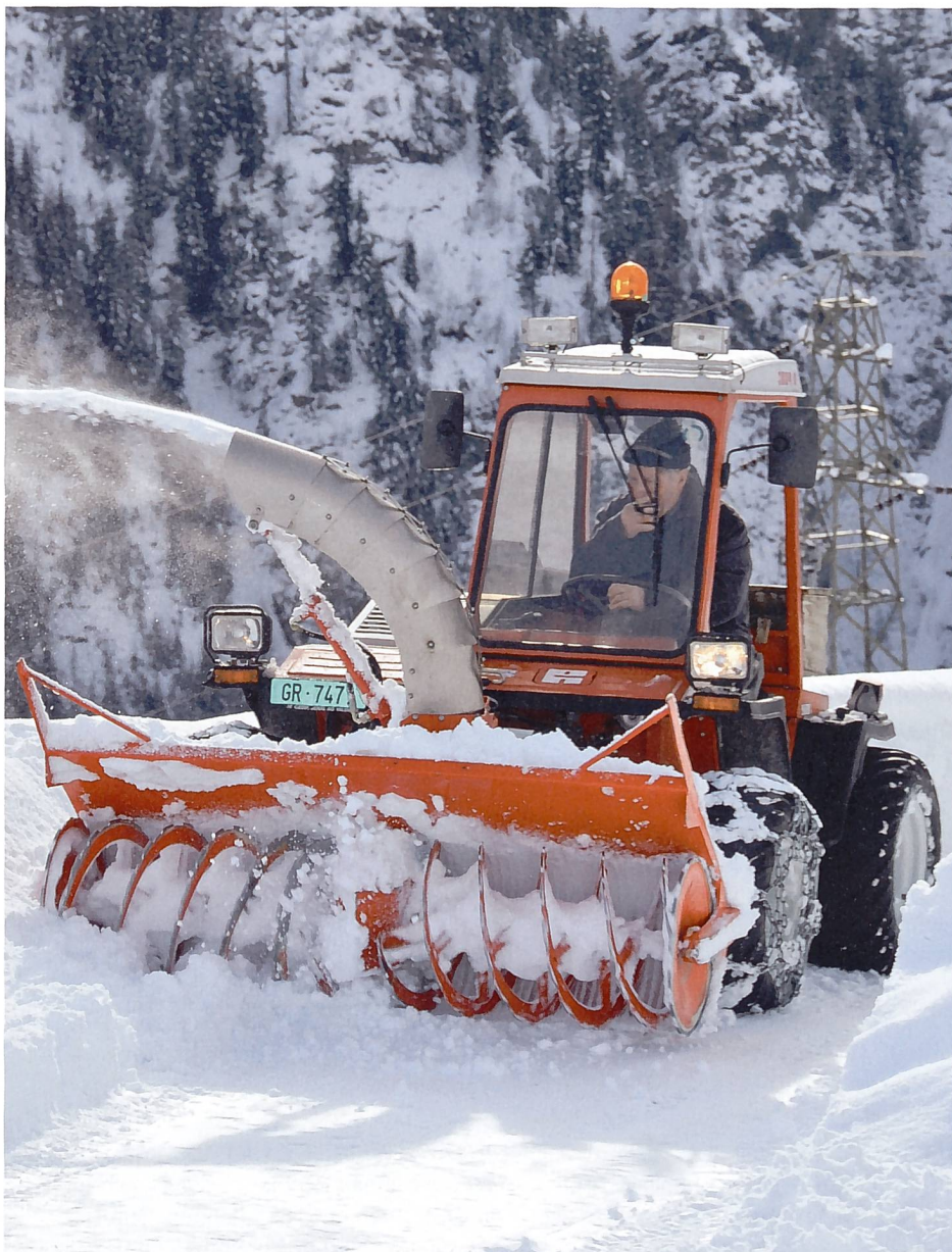
Auf Lokalstrassen und Zufahrtswegen kann die Kombination Zweiachsmäher/Frässchleuder erfolgreich zur Räumung eingesetzt werden. (Foto: Ruedi Hunger)
