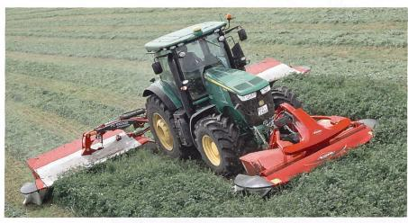
Die Dreifach-Mähkombinationen FC 3525 im Frontanbau und FC 10030 im Heckanbau sind mit wartungsfreien Optidisc-Mähbalken und Überlastsicherung Protectadrive ausgestattet.
