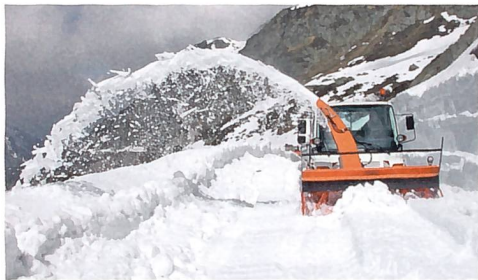
Grosse Schneehöhen müssen bei Passöffnungen oft in mehreren Schichten abgetragen werden. Hier eine Frässhleuder im Räumeeinsatz.
