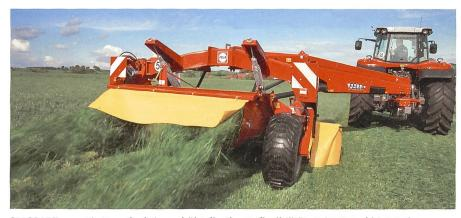
SM 3065 Trans: Die Transfunktion erhöht die Einsatzflexibilität. DriveGuard bietet eine sichere Sollbruchstelle mit rascher Wiederinstandstellung.
