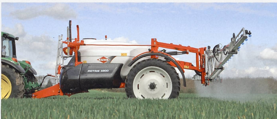
Bei der neuen Anhängespritze Metris 3200 ist die Aufwandmenge geringer, 3200 l, dafür das Gestänge breiter.
