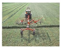
Hydraulische Verstellung der Kurvenbahn, damit die Zinken über dem Ouerschwad nicht in Rechstellung sind.
