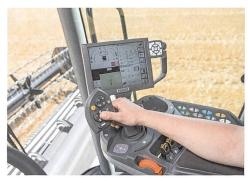
Mit dem Variotronic-Bedienkonzept verfolgt Fendt seine EIN-Terminal-Strategie. Von den Traktoren der Baureihen 500 bis 900 über die Katana-Feldhäcksler bis zu den Mähdreschern können alle Funktionen wie Einstellungen, Spurführung und Dokumentation über den gleichen Terminal eingegeben werden.
