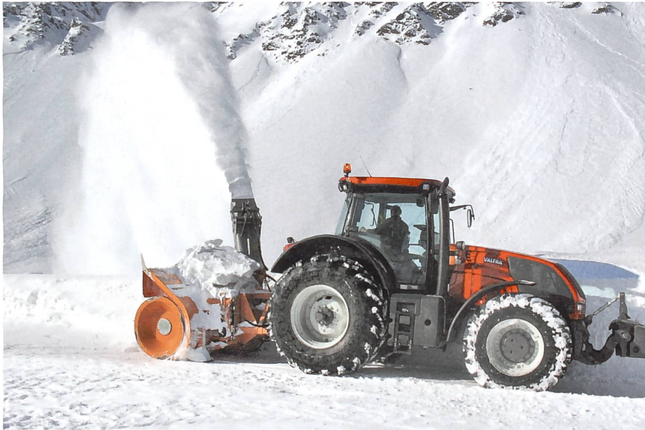
Traktoren mit Rückfahrvorrichtung eignen sich gut für den schweren Räumeeinsatz.
