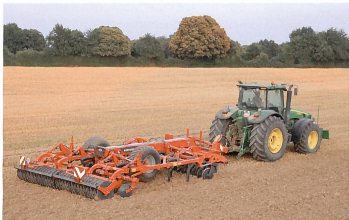
Die Kombi-Tiefgrubber Performer 4000 (Bild) und 5000 ermöglichen in einer Überfahrt die Bearbeitung nach der Ernte von flach bis tief.
