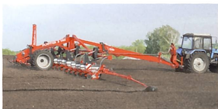
Die Einzelkornsämaschine Planter 3 TRS mit 12 m Arbeitsbreite kommt mit einer Traktorleistung von 120 PS aus.
