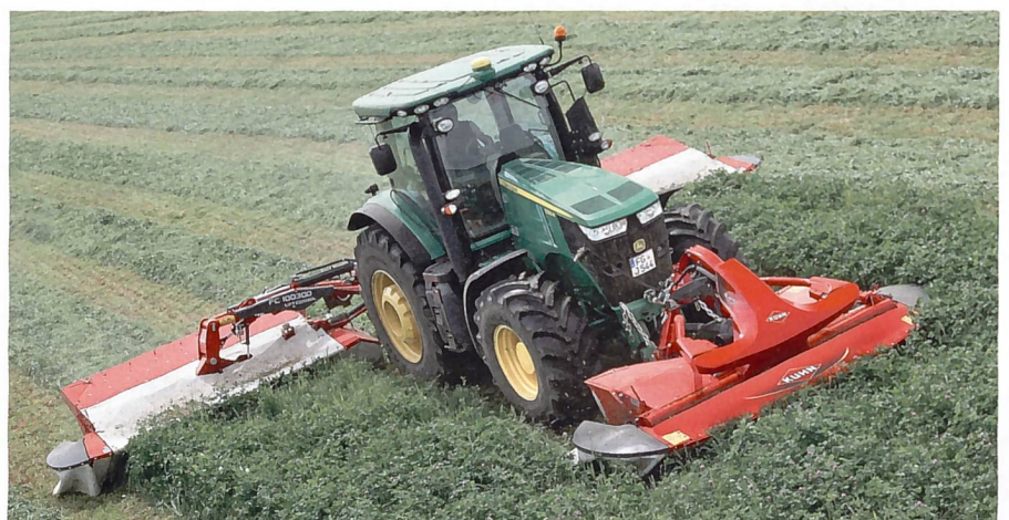
Die Dreifach-Mähkombinationen FC 3525 im Frontanbau und FC 10030 im Heckanbau sind mit wartungsfreien Optidisc-Mähbalken und Überlastsicherung Protectadrive ausgestattet.
