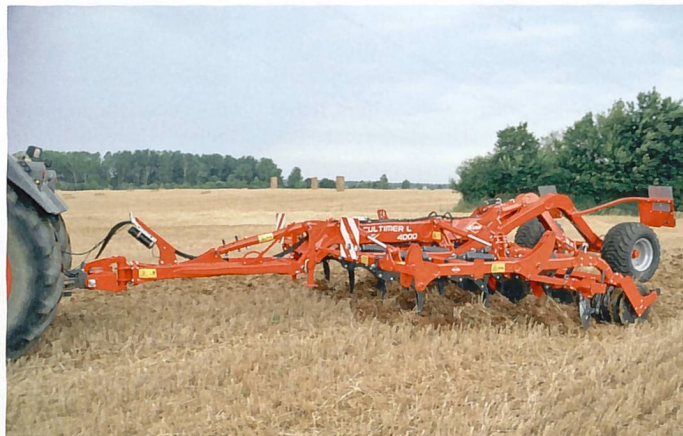
Die gezogenen dreibalkigen Zinkengrubber Cultimer L (hier der 4000er) eignen sich für flache, mittlere und tiefe Bearbeitung bis 35 cm.
