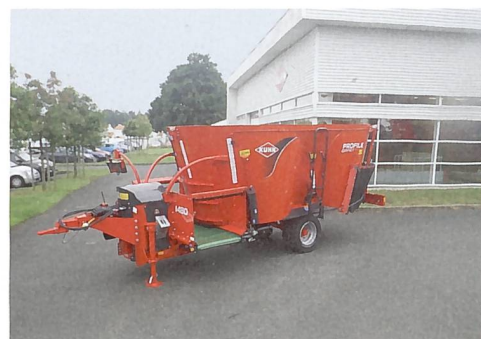
Der Futtermischwagen Profile 80 Compact verfügt über eine enge Spurweite.
