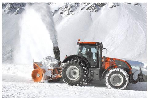
Traktoren mit Rückfahrvorrichtung eignen sich gut für den schweren Räumeinsatz.
