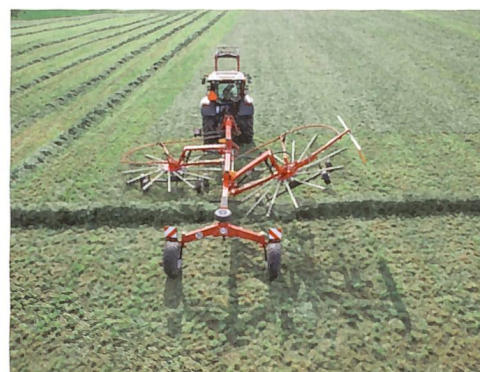
Hydraulische Verstellung der Kurvenbahn, damit die Zinken über dem Querschwad nicht in Rechstellung sind.
