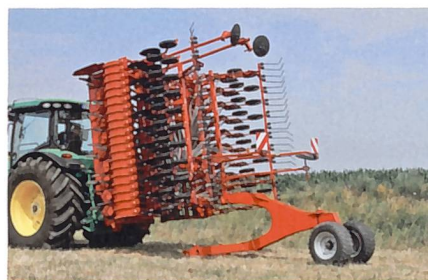
Die neue Säkombination CSC 6000 besitzt einen abnehmbaren Transportrahmen.
