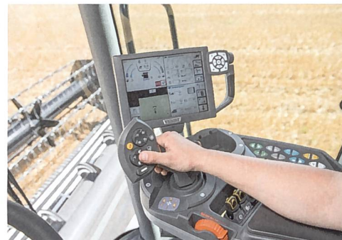
Mit dem Variotronic-Bedienkonzept verfolgt Fendt seine EIN-Terminal-Strategie. Von den Traktoren der Baureihen 500 bis 900 über die Katana-Feldhäcksler bis zu den Mähdrechern können alle Funktionen wie Einstellungen, Spurführung und Dokumentation über den gleichen Terminal eingegeben werden.
