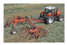
Der aufgesattelte Kreiselschwader mit mittiger Schwadablage: GA 9531.
