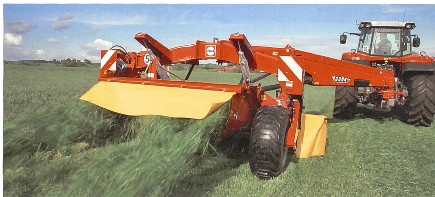
SM 3065 Trans: Die Transfunktion erhöht die Einsatzflexibilität. DriveGuard bietet eine sichere Sollbruchstelle mit rascher Wiederinstandstellung.
