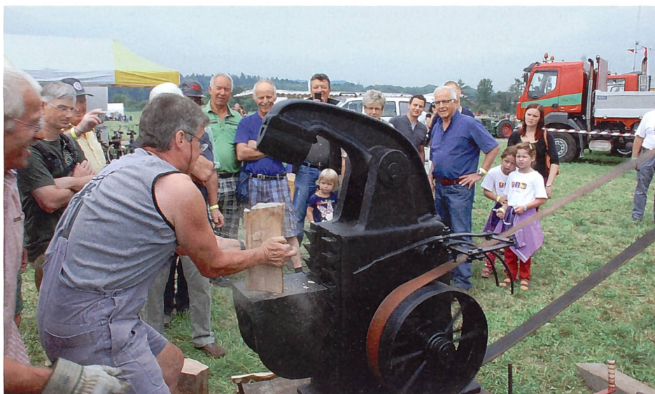
... und bald treibt er via Lederriementransmission eine Holzspaltmaschine der «Landmaschinen- & Werkzeugfabrik A.-G., H. Bossart» aus Reiden LU.
