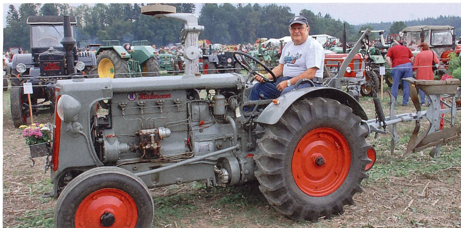
Felix Näf ist mit seinem Hürlimann D100 von 1948 samt Pflug aus Villigen AG angereist; die Kupplung und das Bremspedal befinden sich auf der rechten Seite.
