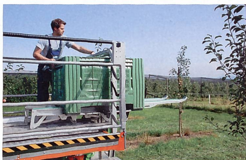
Die Scherenhubtechnik der Samatec-Hebebühne erlaubt ein einfaches Rollen der (mit Äpfeln gefüllten) Grosskisten nach hinten zum Abladen.
