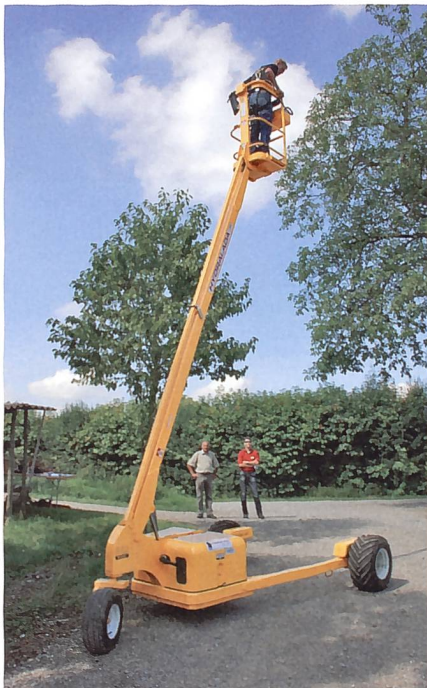
Der Hebelift Hydralada Maxi 540 wird hydraulisch betätigt und von einem Benzinmotor angetrieben.
