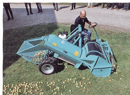
Die Krauss-Obstauflesemaschine besitzt einen bis auf 275 cm kippbaren Ladebunker.
