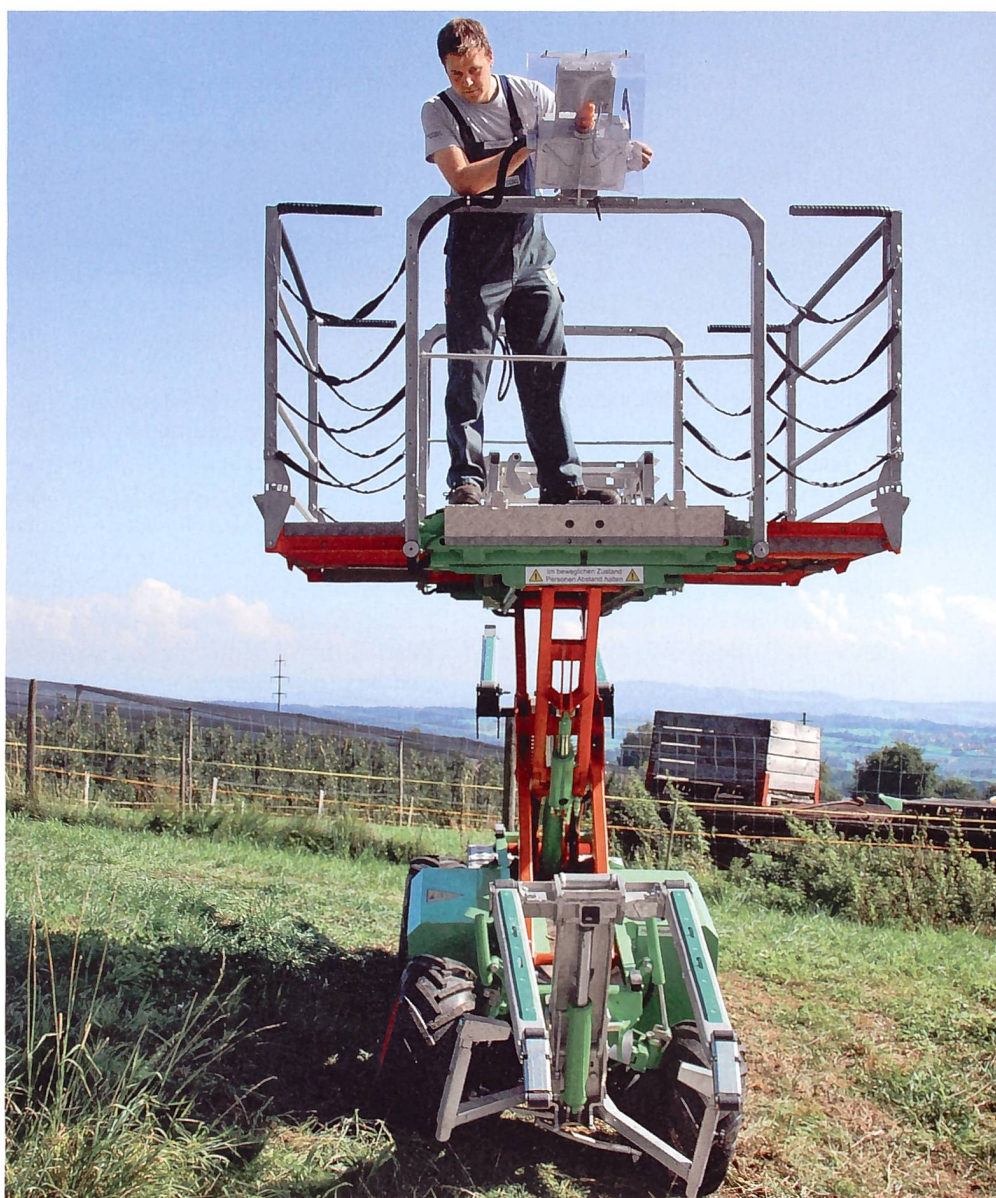
Die Hebebühne Samatec EVO4 für den Niederstammobstbau regelt automatisch den Hangaussgleich bei Seitenneigung bis 20%, in Hangrichtung bis 45%. (Bilder: Dominik Senn)
