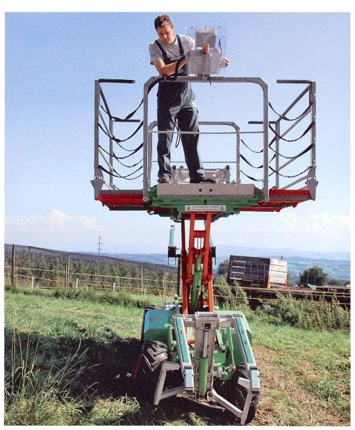
Die Hebebühne Samatec EVO4 für den Niederstammobstbau regelt automatisch den Hangausgleich bei Seitenneigung bis 20%, in Hangrichtung bis 45%. (Bilder: Dominik Senn)
