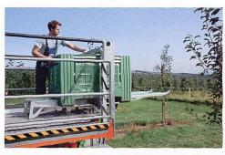
Die Scherenhubtechnik der Samatec-Hebebühne erlaubt ein einfaches Rollen der (mit Äpfeln gefüllten) Grosskisten nach hinten zum Abladen.
