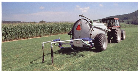
Das System Mai weist eine Arbeitsbreite von 7 m auf und ist rund 260 kg schwer. Es ist auf kleine Betriebe mit einem grossen Anteil steilem Gelände zugeschnitten.
