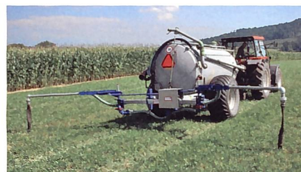
Das System Mai weist eine Arbeitsbreite von 7 m auf und ist rund 260 kg schwer. Es ist auf kleine Betriebe mit einem grossen Anteil steilem Gelände zugeschnitten.
