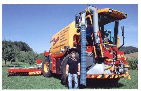
Das Eindrillen mit einem Gülle-Selbstfahrer zeigt Lohnunternehmer Andreas Bobst aus Aedermannsdorf. Dank der Zweirad-, Vierrad- und Hundeganglenkung ist das Fahrzeug bodenschonend, wendig und hangtauglich. Das System ist hervorragend geeignet für die Güllesaat mit trockenem Grassamen, für Grünland-Nachsaat und für Getreidesaaten.
