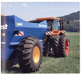
tels einer Injektionstechnik wird die Gülle direkt in die obere Erdschicht eingebracht. Die Einbringtiefen können, je nach Kul-
