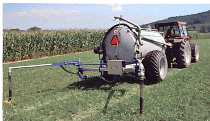
Das System Mai weist eine Arbeitsbreite von 7 m auf und ist rund 260 kg schwer. Es ist auf kleine Betriebe mit einem grossen Anteil steilem Gelände zugeschnitten.
