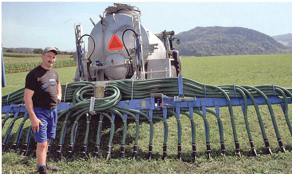
Felix Rieder aus Rothenfluh verwendet auf seinem Betrieb in Gelterkinden das System Schleppschuh am Fass mit Vogelsang-Vertikalverteilkopf; das Kaufkriterium war, den Verteiler an sein herkömmliches Güllefass anbauen zu können.
