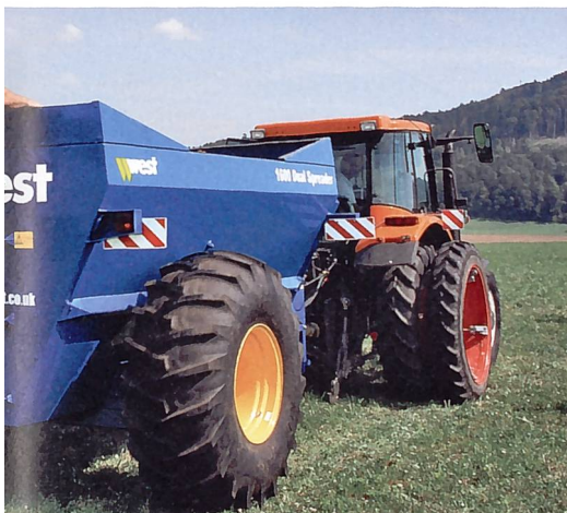
Das Eindringen mit einem Gülle-Selbstfahrer zeigt Lohnunternehmer Andreas Bobst aus Aedermannsdorf. Dank der Zweirad-, Vierrad- und Hundeganglenkung ist das Fahrzeug bodenschonend, wendig und hangtauglich. Das System ist hervorragend geeignet für die Güllesaat mit trockenem Grassamen, für Grünland-Nachsaat und für Getreidesaaten.
