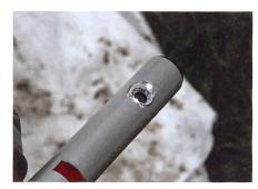
Das Kameraauge mit Weisslicht-Beleuchtung befindet sich seitlich an der Rohrspitze.
