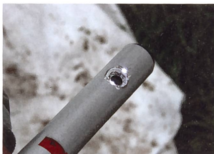
Das Kameraauge mit Weisslicht-Beleuchtung befindet sich seitlich an der Rohrspitze.
