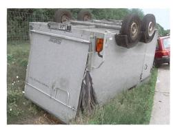
Gerät ein Anhänger ins Schlingern, kann sich das System Zugfahrzeug–Anhänger stark aufschaukeln. Experten raten in dieser Situation, auf Lenkkorrekturen zu verzichten und das Lenkrad in erster Linie still zu halten sowie mässig zu bremsen. Wer jedoch solche «Grenzerfahrungen» nicht unbedingt will, achtet auf genügend Reifendruck und hält die zulässige Geschwindigkeit ein. Eine zusätzliche Verbesserung ist auch durch die Montage einer Antischlingerkupplung möglich.
