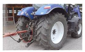
Bei Traktoren mit grosser Bereifung muss das Zugmaul weit hinter dem Achszentrum angebracht werden. Bei einem Nachstossen des Anhängers in der Kurve führt dies zu einem ausgeprägten Übersteuern oder begünstigt das Ausbrechen der Traktorhinterachse.
