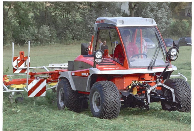
Metrac G5X: Zweiachsmäher eignen sich zum Mähen, Zetten, Schwadenziehen usw. (Bilder: Werkbilder/Ruedi Hunger)
