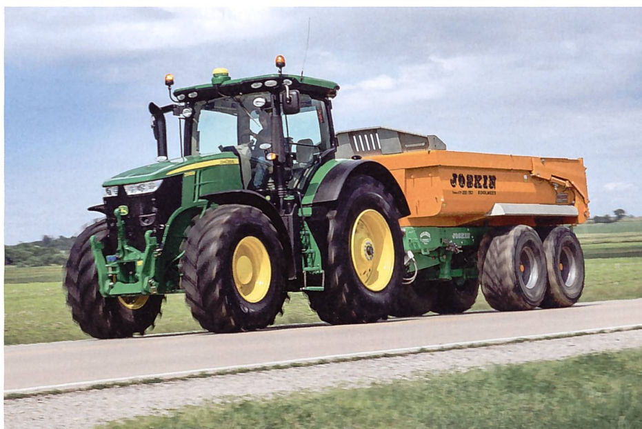
John Deere stattet vorerst nur das neue 7R-Flaggschiff 7310R mit der neuesten Motortechnologie aus, bei der jetzt auch SCR zum Einsatz kommt.
