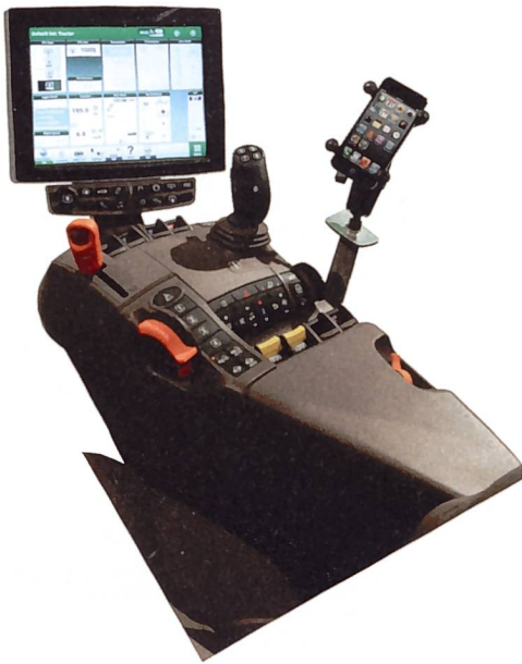
Der Fahrersitz der neuen Command-View-III-Kabine der Baureihen 7R/8R kann um 40° nach rechts gedreht werden und ist mit einem neuen Command-Arm ausgestattet.
