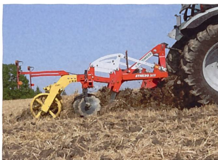
Synkro 3020, der neue zweibalkige Grubber aus dem Hause Pöttinger. (Werkbild)
