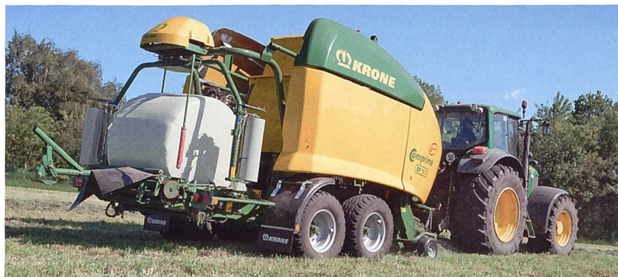
Die Baureihe Comprima X-treme von Krone ist eine Presse für extreme Bedingungen. (Werkbild)
