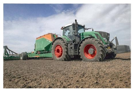
Fendt setzt bei den Baureihen 800 und 900 weiterhin auf Motoren von Deutz. Für die Abgasstufe 4 kommen eine zweistufige Turboaufladung mit Zwischenkühlung, externe Abgasrückführung, ein passiver Partikelfilter sowie SCR zum Einsatz.
