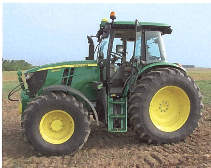
Die Modelle der Baureihe 6MC haben die Kabine der Serie 5R und eine einfachere Ausrüstung erhalten.
