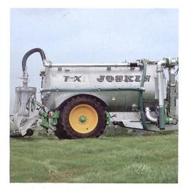
Die vier aneinandergereihten Räder des Tetrax2 sorgen für einen kleinstmöglichen Bodendruck, was der Bodenstruktur zugutekommt. (Werkbild)
