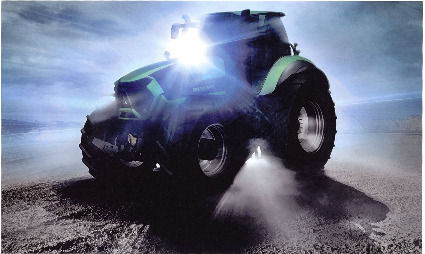
Im Bild noch surreal, an der AGRITECHNICA in Hannover zum Anfassen: Die vier Modelle der Deutz-Fahr-Serie 9 besitzen eine Motorleistung von 270 bis 340 PS und sind mit stufenlosen TTV-Getrieben ausgerüstet. (Werkfotos)
