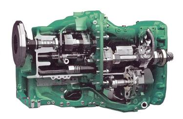
le dar, was zu weicheren Schaltvorgängen führen soll. Das für den Leistungsbereich 85 bis 115 PS vorgesehene Getriebemodell TPT11 wird nach Angaben von ZF bereits in Serie gebaut werden und dürfte u.a. von Argo in McCormick- und Landini-Modellen eingebaut werden.
