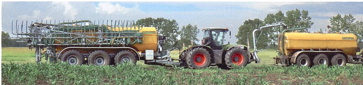
Der Profi Fant von Zunhammer ist mit einem Frontdock-System ausgestattet; damit kann er in nur drei Minuten befüllt werden.
