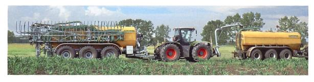
Der Profi Fant von Zunhammer ist mit einem Frontandock-System ausgestattet; damit kann er in nur drei Minuten befüllt werden.
