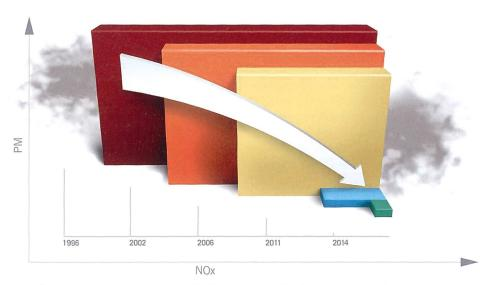
Beim Übergang von der Stufe 3A (gelb) auf die Stufe 3B (blau) musste die Partikelmasse massiv reduziert werden, beim bevorstehenden Übergang auf die Abgasstufe 4 (grün) liegt der Fokus auf der Reduktion der Stickoxide (NO<sub>v</sub>).
