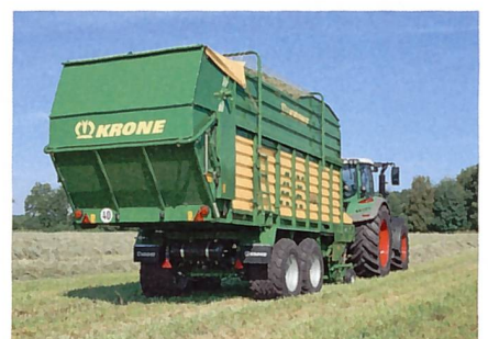
Der AX 310 GL/GD von Krone kann von Traktoren ab ca. 100 PS eingesetzt werden.
