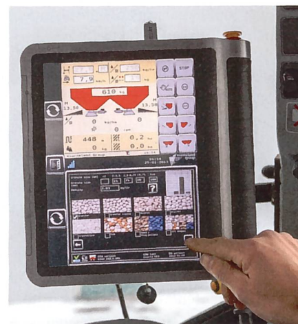
Absteigen war gestern: Dank SpreadersetApp werden Dünger und Streumenge für GEOspread-Düngerstreuer per Knopfdruck ausgewählt.
