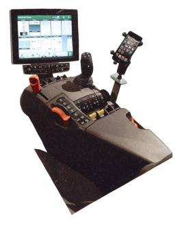
Der Fahrersitz der neuen Command-View-III-Kabine der Baureihen 7R/8R kann um 40° nach rechts gedreht werden und ist mit einem neuen Command-Arm ausgestattet.
