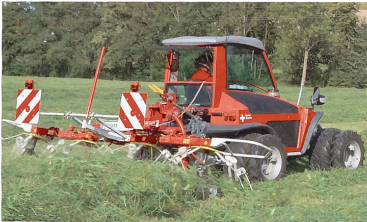
AEBI TT205: Obwohl der Frontanbau dominiert, werden Zweiachsmäher heute in der Regel auch mit einer Heckhydraulik ausgerüstet.
