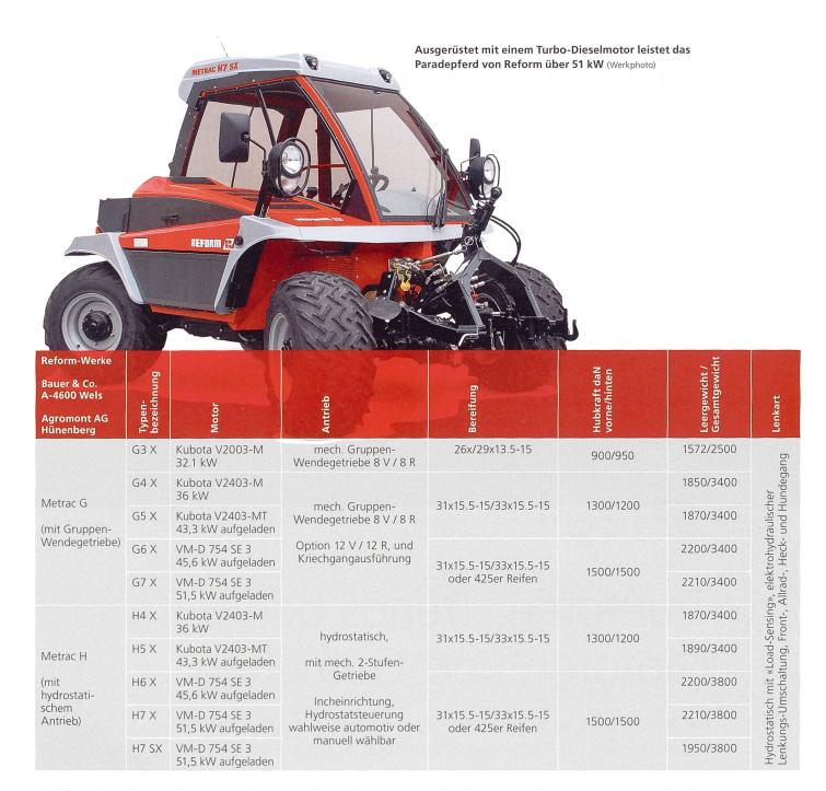
Multifunktionshebel zur Verfügung. Die Hydraulikpumpe der grossen Modelle fördert mehr als 24 Liter Öl je Minute; dies bei einem maximalen Druck von 195 bar. Das Hubwerk der G6/7 bzw. H6/7 verfügt über eine elektrohydraulische Geräteentlastung inklusive Schwingungsdämpfung. Vollbestückt stehen vorne 10, hinten 8 Steckkupplungen für hydraulische Anwendungen zur Verfügung.
