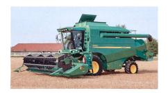
Korntank geliefert wird, fasst der Tank des W440-PTC 8000 Liter und kann mit bis zu 100 l/s entleert werden.
