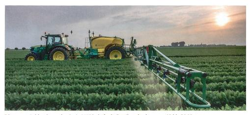
Die neuen Feldspritzen der Serie M700 sind mit Gestängebreiten von 18 bis 30 Meter erhältlich.
