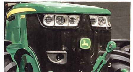
Das neue 360°-LED-Beleuchtungspaket der Serie 7R besteht aus Mehrfach-LED-Scheinwerfern.
