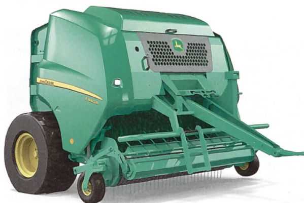
Die Rundballenpresse F 440R ist mit den Förderorganen aus der Serie 900 ausgerüstet.
