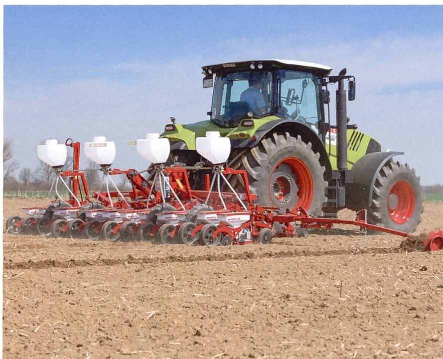
Mit GEOseed-Applikation können die Saatkörner über die Maschinenbreite hinaus im Quadrat- oder Dreieckverband abgelegt werden.
