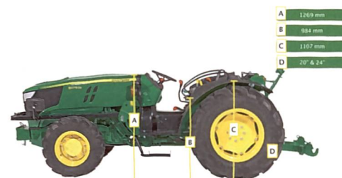
Mit dem neuen Modell 5GL bietet John Deere neu den niedrigsten Traktor mit 75 oder 85 PS auf dem Markt an.
