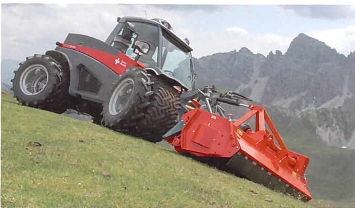
Aebi TT280: Dank Motorleistungen bis 80 kW können auch grosse Mulchgeräte betrieben werden.
