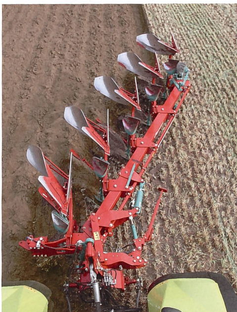
Mit FURROWcontrol werden gleichmässige Furchenbreiten und eine Pflugfurche ohne Kurve realisiert. (Werkphotos)
