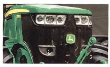
Das neue 360°-LED-Beleuchtungspaket der Serie 7R besteht aus Mehrfach-LED-Scheinwerfern.
