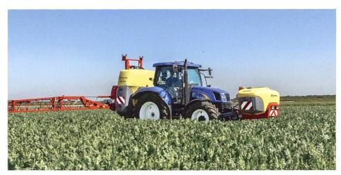
Heck- und Fronttank lassen sich im Multi-Tank-System zu einer Einheit kombinieren
