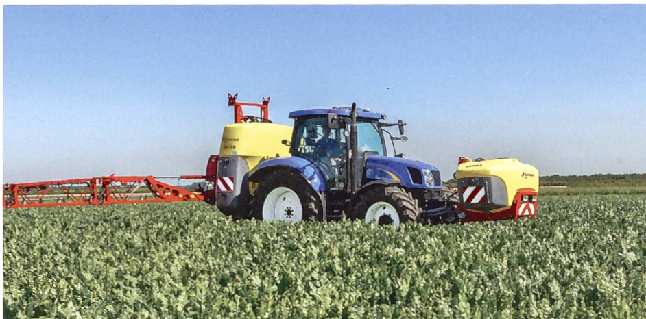
Heck- und Fronttank lassen sich im Multi-Tank-System zu einer Einheit kombinieren
