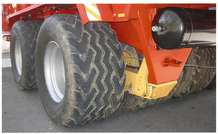
Reifenprofil und Bremsen entscheiden über die Hangtauglichkeit: Mit der Wahl einer AS-Bereifung bei dieser Mehrfachpendelachse könnte das seitliche Abrutschen bei der Schichtlinienfahrt noch vermindert werden. Wichtig ist, dass sämtliche Räder eine Bremse haben, denn sonst können die nötigen Kräfte nicht auf den Boden übertragen werden. Dies gilt auch bei Strassenfahrten. (Bilder: Ruedi Gnädinger)
