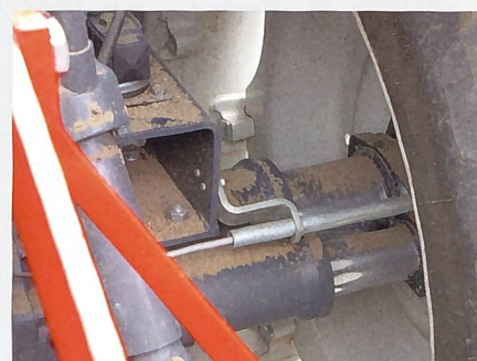
Auf der Hinterachse wird die Spurbreite hydraulisch verstellt.
