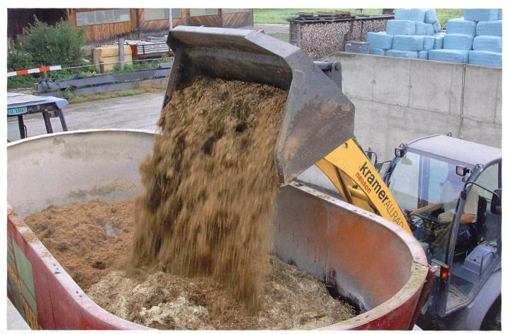
Fremdbefüller benötigen ein zweites Fahrzeug zur Befüllung. (Bild: Ruedi Hunger)
