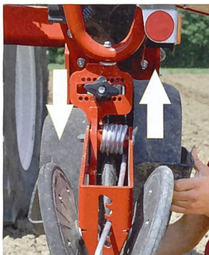
Das Schwingtandem glättet Bodenunebenheiten, indem zwischen den beiden Tiefenführungsrollen ein Pendelausgleich besteht.
