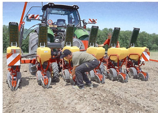
Ein Füllstandsensorm am dritten Säaggregat überwacht die Saatgutmenge und löst Alarm aus, wenn der Vorrat zur Neige geht.
