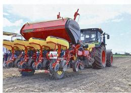
Das Einklappen der Flügelsektoren bei gezogenen Maschinen kann manuell oder hydraulisch erfolgen. Mit Reihenweiten von 75 cm und weniger wird damit eine Transportbreite von 3 m erreicht.
