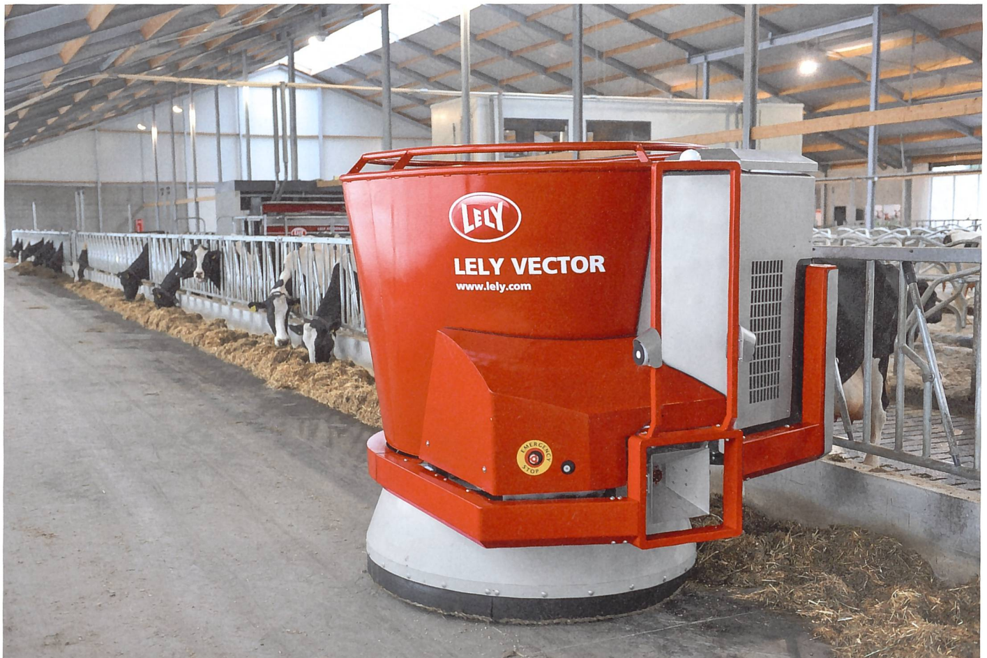
Dieser automatische Fütterungsroboter erfüllt neben dem Futteraustag noch andere Aufgaben. Zusätzlich wird die (Rest-)Futterhöhe sensorisch erfasst, entsprechend erfolgt dann der Futteraustag. Bei der Durchfahrt wird gleichzeitig das Futter nachgeschoben. (Werkbilder)
