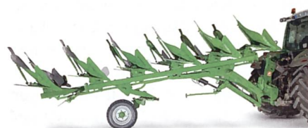
Das Stützrad wird mit einem einfachen Handgriff zum Transportfahrwerk.
