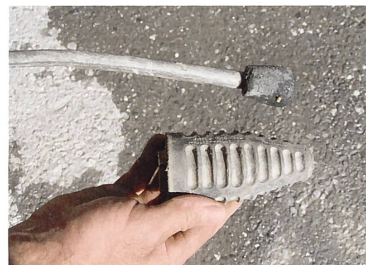
Der Hochdruckreiniger ist nur die «halbe Wahrheit», ebenso entscheidend ist das Zubehör, vor allen Spritzpistole, Strahlrohr und Düsenausrüstung (im Bild Flachstrahldüse und Dreckfräser).
