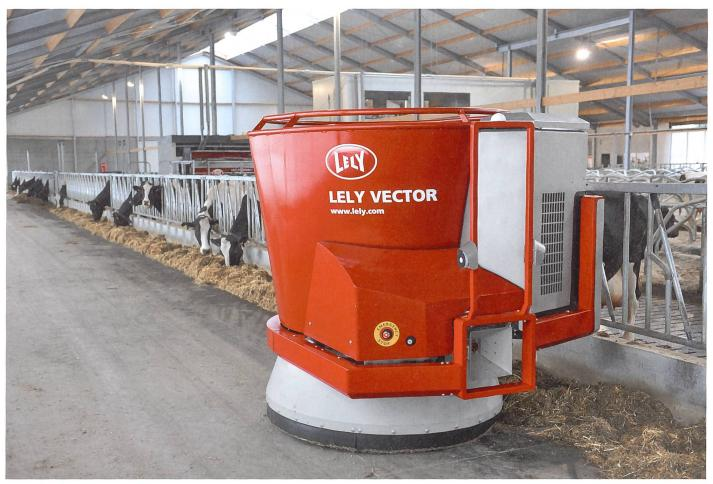
Dieser automatische Fütterungsroboter erfüllt neben dem Futteraustrag noch andere Aufgaben. Zusätzlich wird die (Rest-)Futterhöhe sensorisch erfasst, entsprechend erfolgt dann der Futteraustrag. Bei der Durchfahrt wird gleichzeitig das Futter nachgeschoben. (Werkbilder)
