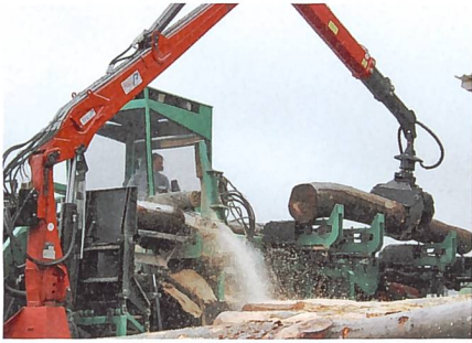
Während des Sägevorgangs erfolgt das Bestücken der Rundholzauflage mit einem Baumstamm.
