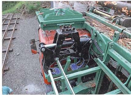
Die Spaltzange bringt 26 t Beisskraft für das Vorspalten auf.
