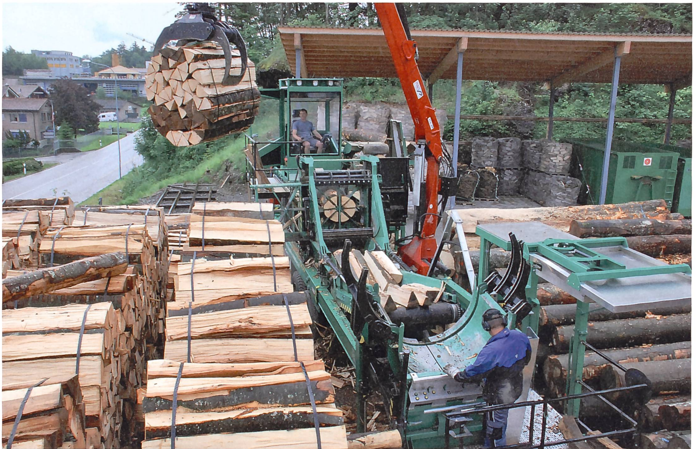
Die mobile Holzspaltanlage der von Atzigen AG wird von Inhaber Franz Odermatt in der Kabine und von einem weiteren Mitarbeiter bedient; der Kran hievt gerade ein Sterbündel vom leeren Bündlerkorb weg, um anschliessend sofort einen nächsten Baumstamm auf die Rundholzaufgabe (rechts neben der Kabine) zu heben, während parallel zu diesen Vorgängen Rundholz gesägt, gespalten und die Scheiter per Transportband zum Bündlerkorb befördert werden. (Bilder: Dominik Senn)
