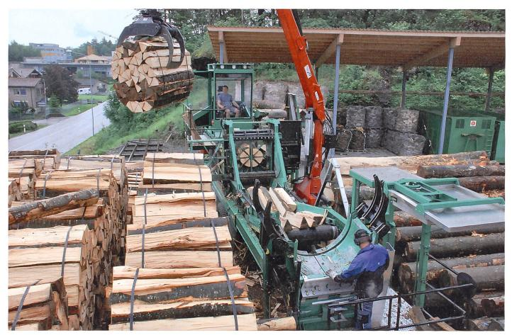
Die mobile Holzspaltanlage der von Atzigen AG wird von Inhaber Franz Odermatt in der Kabine und von einem weiteren Mitarbeiter bedient; der Kran hievt gerade ein Sterbündel vom leeren Bündlerkorb weg, um anschliessend sofort einen nächsten Baumstamm auf die Rundholzauflage (rechts neben der Kabine) zu heben, während parallel zu diesen Vorgängen Rundholz gesägt, gespalten und die Scheiter per Transportband zum Bündlerkorb befördert werden. (Bilder: Dominik Senn)
