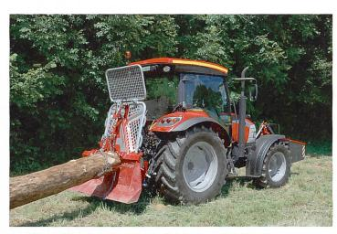
Eine Seilwinde ist für sicheres Arbeiten unerlässlich. Sie muss aber die Sicherheitsanforderungen erfüllen. Der Traktor sollte pro Tonne Zugkraft zirka 12 PS haben. Wobei nicht die Stärke, sondern das Gewicht massgebend ist.
