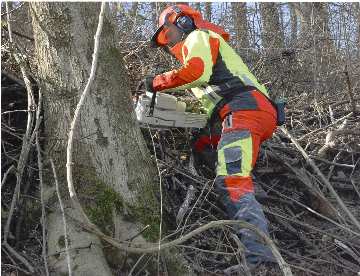
Moderne Forstkleider sind angenehm zu tragen, leicht, robust, farbig, funktionell, wasserabstossend und schützen vor Verletzungen. Sie sind auch im Sommer leichter zu tragen. (Bilder: BUL)
