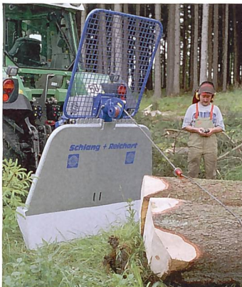
Dank Funkfernsteuerung kann sich der Bediener an einer sicheren Stelle aufhalten.
