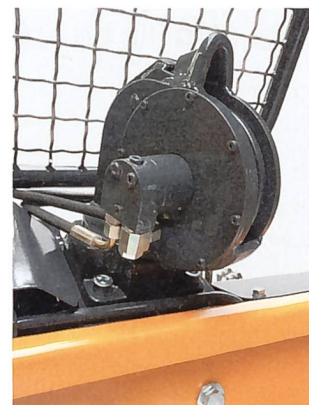
Dieser hydraulische Seilausstoss dient auch als Seileinzugsbremse.
