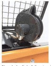
Dieser hydraulische Seilausstoss dient auch als Seileinzugsbremse.
