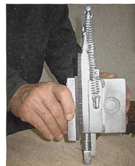
Bei der verkeilenden Scheibenbremse löst sich die Bremse beim Ziehen automatisch.
