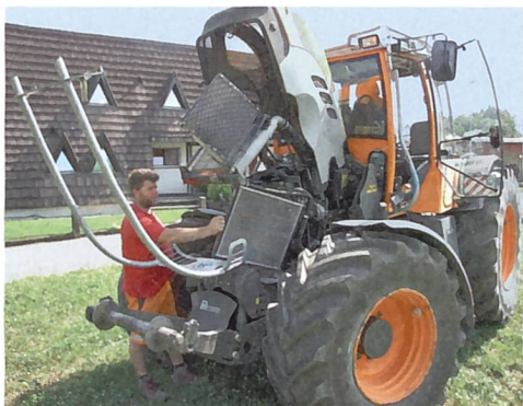
Die Zugänglichkeit für Wartungsarbeiten wie das Reinigen der Kühler ist gut.
