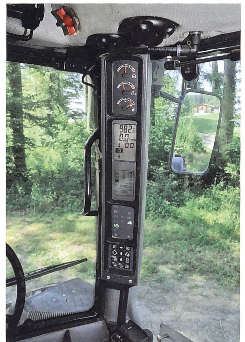
Alle Anzeigen sind im rechten A-Holm gut sichtbar angebracht.
