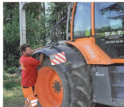
Die Kotflügel können von einer Person werkzeuglos entfernt werden.
