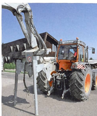
Der Kranaufbau lässt sich dank dem PSA einfach in etwa 10 Minuten entfernen.
