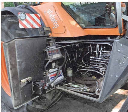
Der Kasten für Batterien und Hydraulikschalter lässt sich auch als Stauraum nutzen.
