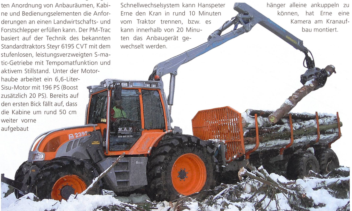
Zusammen mit dem Rückewagen ist der PM-Trac ein vollwertiger Forwarder. (Bild: Hanspeter Erne)
