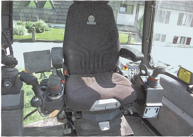
Der Sitz inklusive Bedienung kann jederzeit während der Arbeit um 220 Grad elektrisch gedreht werden. (Bilder: Ruedi Burkhalter)
