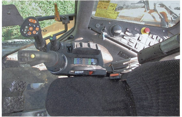
Auf der rechten Armlehne sind neben dem Hauptjoystick der Multicontroller und die Bedienung der Steuergeräte angebracht.
