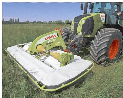
Die neuen Disco 3200 Frontmähdwerke haben einen umlaufenden Schutzbügel
