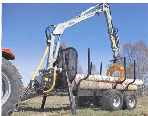
A-Stützen werden teleskopartig ein- und ausgefahren und benötigen daher seitlich wenig Freiraum.
