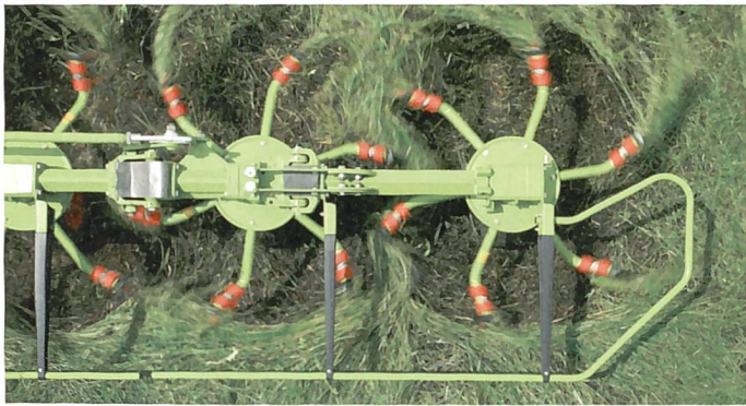
«Max Spread» arbeitet mit einer neuartigen, tangentialen Befestigung der Zinken.
