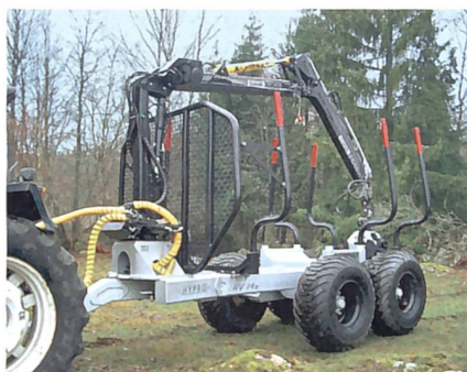
Holzrückewagen ohne Abstützung für Ladarbeiten.
