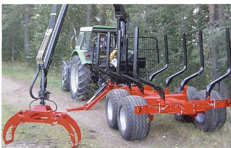
Seitlich abklappbare Stützen (Flap down) benötigen genügend Freiraum.
