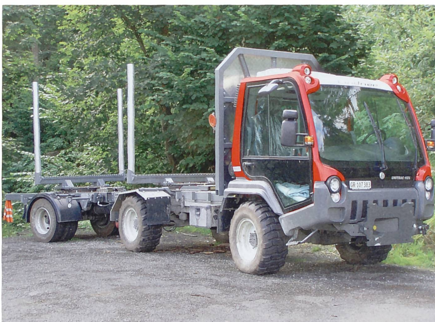
Transporter mit Langholz-Aufleger können eine Lücke zwischen verschiedenen Transportfahrzeugen schliessen.
