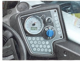
Die Kabine ist neu gestaltet und 10 cm breiter als bei den Vorgängermodellen. Die Lenkungsart lässt sich an einem Drehschalter (kleines Bild) jederzeit ändern.
