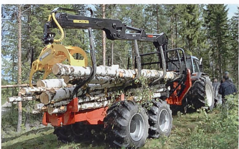
Die Anzahl Rungen hängt vom Sortiment ab, das geladen bzw. geführt wird. Die in der Grundausrüstung vorgesehene Rungenzahl kann bei den meisten Fabrikaten erhöht werden.
