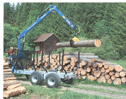
Oft stehen nur Reichweite und Hubkraft im Mittelpunkt der Kranauswahl. Schwenkwerk, Knickarm mit/ohne Kniehebel oder Teleskopaussschub sind ebenso wichtige Details im täglichen Gebrauch.
