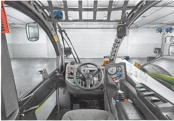
Die Kabine ist neu gestaltet und 10 cm breiter als bei den Vorgängermodellen. Die Lenkungsart lässt sich an einem Drehschalter (kleines Bild) jederzeit ändern.
