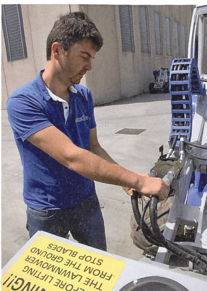
Automatisierter Gerätewechsel und leicht zu bedienende Schnellkupplung der Hydraulikleitungen.
