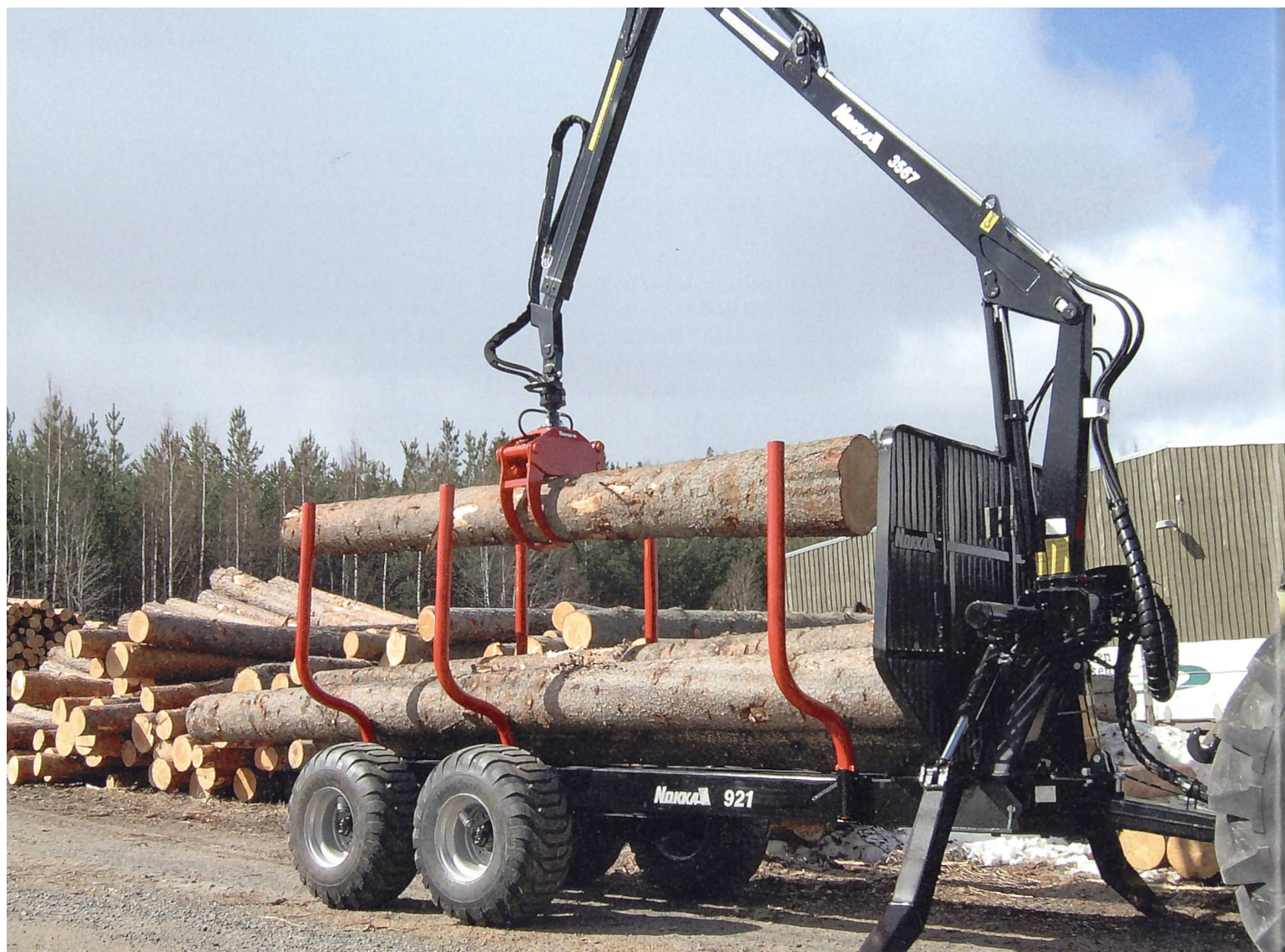
Rückewagen mit Leiterrahmen und Boogie-Fahrwerk: Der aufgebaute Kran stützt sich über «Flap down»-Stützen ab und wird aus der Traktorkabine gesteuert. (Bilder: Werkbilder/Ruedi Hunger)
