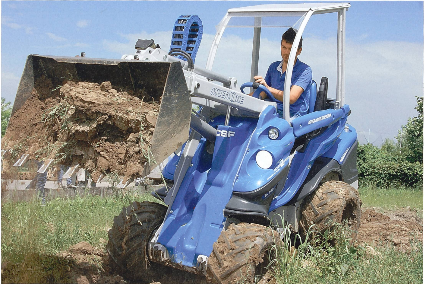
Kraftvoller Einsatz des Spitzenmodells SL840 DTP mit zwei Geschwindigkeitsbereichen. Der teleskopierbare Arm erreicht eine Höhe von drei Metern. (Bilder: Ueli Zweifel)
