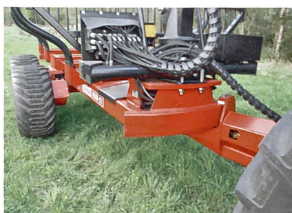
Eine Schwenkdeichsel bedingt mehr bewegliche Teile am Wagen, erhöht aber die Beweglichkeit auf Wandwegen und in Rückegassen.
