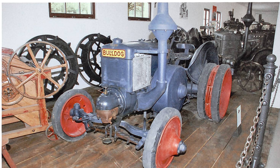
Der Lanz-15/30 von 1929 aus Mannheim (D) ist ein Einzylinder und der erste Kühler-Bulldog.
