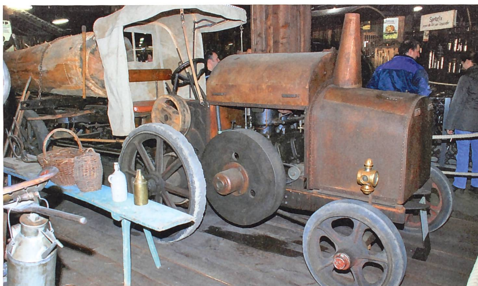
Das MWM-Motorpferd aus Mannheim (D) ist ein Zweizylinder mit Baujahr 1925, der erste deutsche Traktor mit Dieselmotor.
