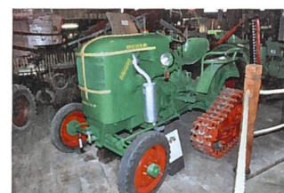
Der Einzylinder Deutz-F1L514/50 von 1951 aus Köln (D) mit Halbraupe; die Anbauketten konnten jederzeit gegen übliche Luftreifen getauscht werden.
