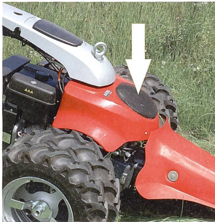
Hydraulische Bauteile erhitzen sich im Betrieb. Diese Wärme wird von Gebläse und Ölkühler abgeführt, daher sind regelmässige Sauberkeitskontrollen angezeigt.
