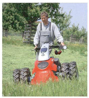
Hydrostatische Antriebskonzepte bewähren sich. Sie bringen mehr Sicherheit und entlasten den Maschinenführer.
