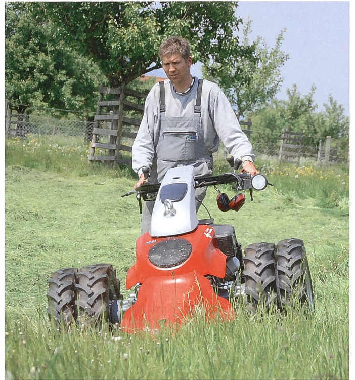
Hydrostatische Antriebskonzepte bewähren sich. Sie bringen mehr Sicherheit und entlasten den Maschinenführer. (Bilder: Ruedi Hunger)
