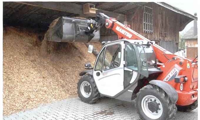
Bewirtschaftung der Holzschneitzelheizung mit dem Manitou MLT 625.
