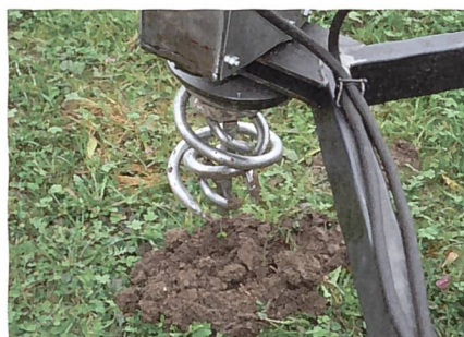
Der Blackenzwirbel der Firma Odermatt Landmaschinen AG nutzt korkenzieherförmige Ausreissorgane, um Blacken am Stück aus der Erde zu ziehen.
