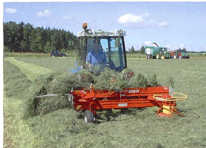
Bandheuer arbeiten nur auf eine Seite, die Futterablage ist nicht immer optimal.
