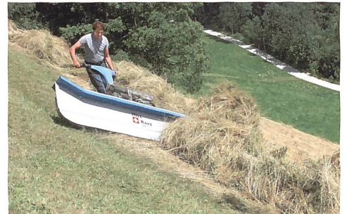
Der Hill-Rake der Firma Erni fördert das Futter mit gefederten Zinken.
