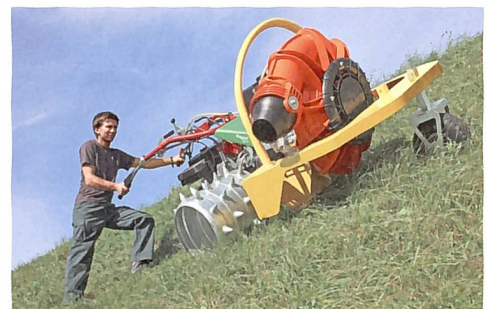
Hay-Blower, starkes Gebläse mit Aufbaumotor von Itin + Hoch.
