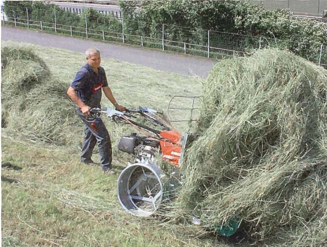
Der Twister nutzt die Schwerkraft, um das Futter links oder rechts abzulegen.
