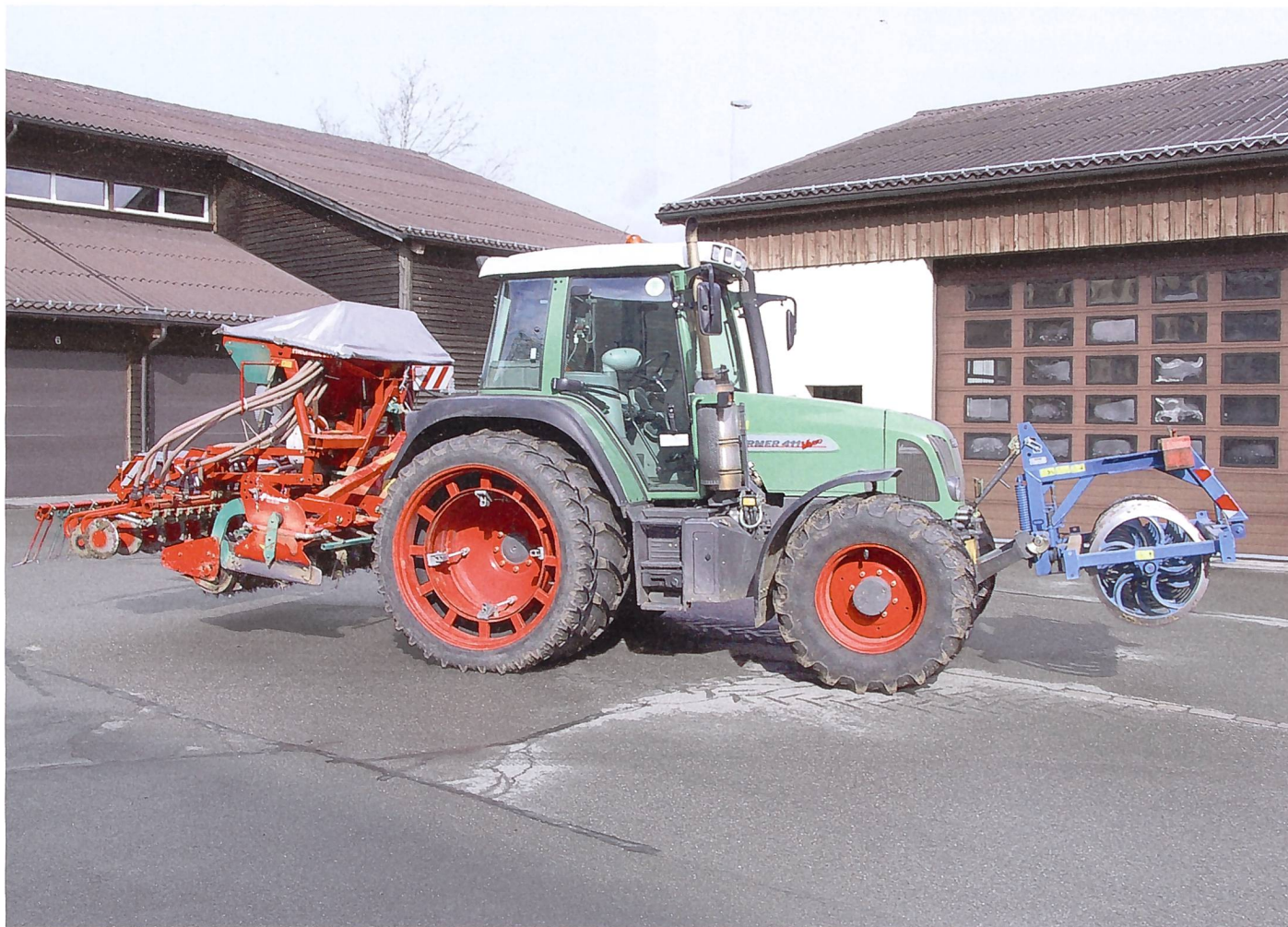
Front- und Heckenbaugeräte verteilen die Gewichte gleichmässig auf den Traktor. (Foto: Agroscope ART)
