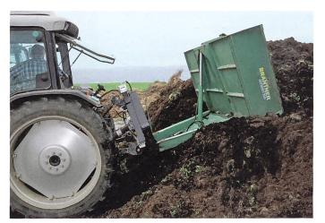
Die hydraulische Kippschaufel wird oft nur für sehr kurze Einsätze angekuppelt.
