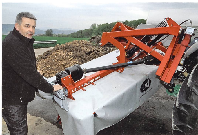
Guido Berger demonstriert, wie am Frontmähwerk das Getriebe nach hinten versetzt wurde.
