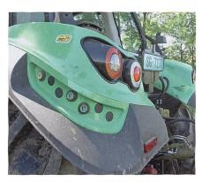
Unter den modernen LED-Rücklichtern lassen sich bis vier Funktionen bedienen.
