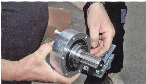
Nachdem das Kupplungsdreieck verriegelt ist, wird der Zapfwellenantrieb hydraulisch eingeschoben.
