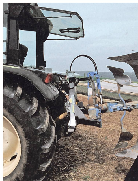
Beim Pflug wurde der Schwerpunkt weit nach hinten geschoben.
