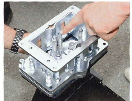
Am Dreieck sind die Faster-Kupplungen fest montiert. Das Gegenstück am Anbaubock wird durch Federn gehalten und kann sich horizontal verschieben bzw. zentrieren.
