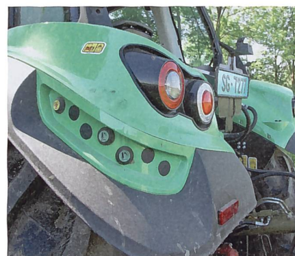
Unter den modernen LED-Rücklichtern lassen sich bis vier Funktionen bedienen.
