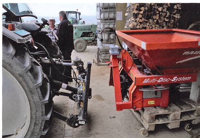
Beim Düngerstreuer wurde der Schwerpunkt nur wenig nach hinten verlagert.
