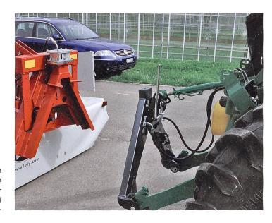
Die Geräte können auch mit Dreiecken ohne Zapfwellenausrüstung gekuppelt werden.
