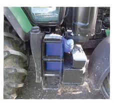
Auf der rechten Seite: zweiter Tankstutzen, Adblue-Tank, Werkzeugkasten, Batteriefach.
