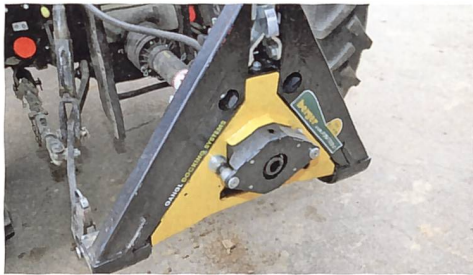
Am Dreieck sind die Faster-Kupplungen fest montiert. Das Gegenstück am Anbaubock wird durch Federn gehalten und kann sich horizontal verschieben bzw. zentrieren.
