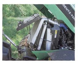
Die vier Kühlerpakete lassen sich zweistufig ausklappen.
