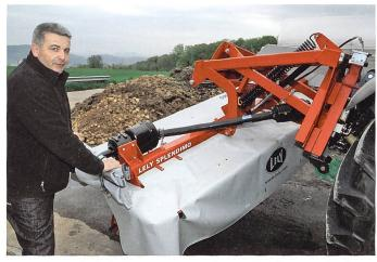
Guido Berger demonstriert, wie am Frontmähwerk das Getriebe nach hinten versetzt wurde.
