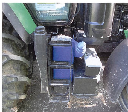
Auf der rechten Seite: zweiter Tankstutzen, Adblue-Tank, Werkzeugkasten, Batteriefach.
