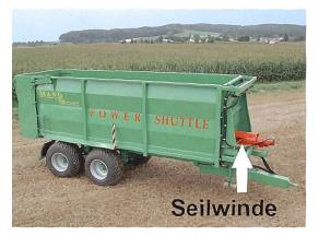
Mang entleert seine Abschiebewagen mittels Windenzug, damit entfallen mehrere oder lange Hydraulikzylinder.
