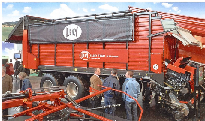
Der Lely-Tigo arbeitet mit einer ungesteuerten Pick-up, und der Förderrotor soll laut Hersteller mit dem engsten Schnittpalt konstruiert sein.
