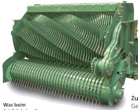
Feldhäcksler die Schneidtrommel, ist beim Hochleistungsladewagen der Schneiderotor. Die geschwungene Form reduziert Spitzenbelastungen.
