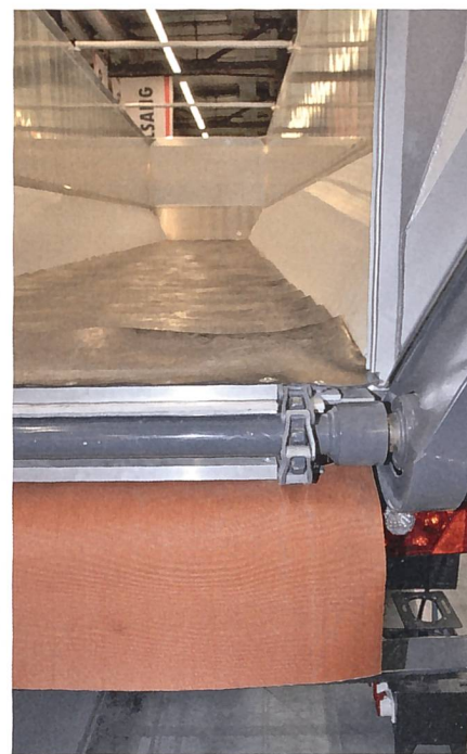
Der Rollboden, wie er von Kröger agroliner angeboten wird, besteht aus einer Kombination von Rollband und Kratzboden.
