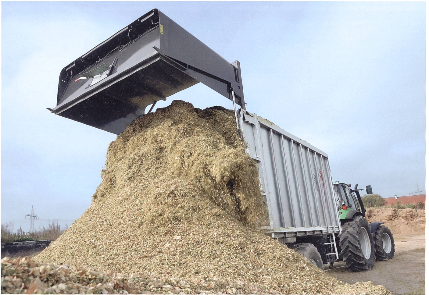
Abschiebetechnik eignet sich für verschiedene Schüttgüter. Zu den Vorteilen dieser Wagen zählen der tief bleibende Schwerpunkt und die rasche Entleerung. (Bilder: Ruedi Hunger/Werkfotos)
