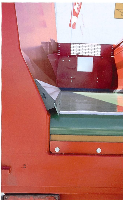
Der Schlüssel zur Dichtheit eines Rollbandwagens liegt bei der seitlich angebrachten Lippendichtung.
