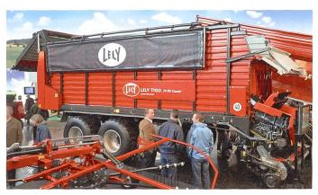
Der Lely-Tigo arbeitet mit einer ungesteuerten Pick-up, und der Förderrotor soll laut Hersteller mit dem engsten Schnittspalt konstruiert sein.
