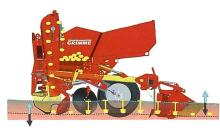
Mit dem Einsatz von TIM wird bei Grimme-Legetechnik trotz variablem Bunkerfüllstand und wechselnder Bodenbeschaffenheit eine konstante Legetiefe realisiert. Das Hubwerk des Traktors wird ohne Eingreifen des Fahrers automatisch geregelt.
