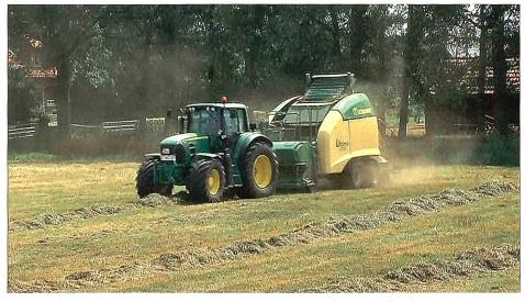
Informationen wie Ballengrösse, Ballenfestigkeit, Bindung starten und Ballen fertig werden dem Fahrer von der Presse bereitgestellt. Der Fahrer muss aufgrund dieser Informationen bis zu 60-mal pro Stunde auf den Traktor einwirken. Mit TIM übernimmt das System die Informationen und steuert den Traktor. Der Fahrer kann sich auf das Überwachen konzentrieren. (Bild: Horstmann Krone)
