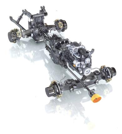
Trac – typischer Antriebsstrang mit Kardanwelle zwischen Getriebe und Hinterachse. Für die Front- und Heckzapfwelle gibt es ein gemeinsames Getriebe.
