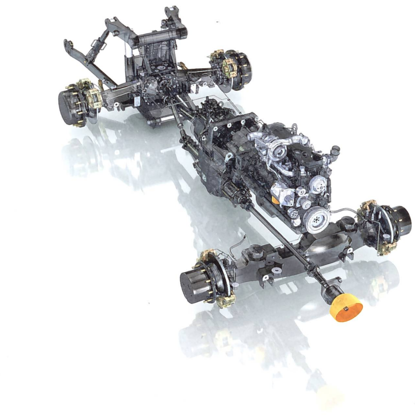
Trac – typischer Antriebsstrang mit Kardanwelle zwischen Getriebe und Hinterachse. Für die Front- und Heckzapfwelle gibt es ein gemeinsames Getriebe.
