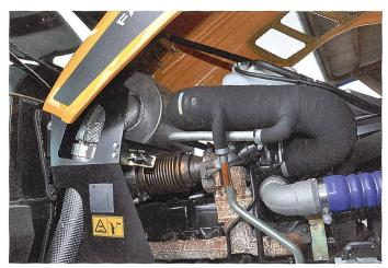
Der Oxidationskatalysator ist unter der Haube platziert, der SCR-Katalysator rechts unten vor der Kabine (nicht sichtbar).
