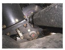
Bei der Feststellbremse kommt ein pneumatischer Federspeicher zur Anwendung.
