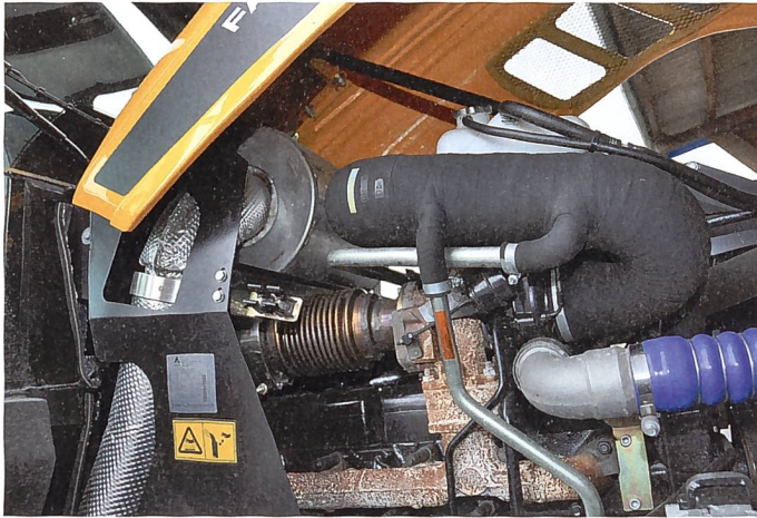
Der Oxidationskatalysator ist unter der Haube platziert, der SCR-Katalysator rechts unten vor der Kabine (nicht sichtbar).
