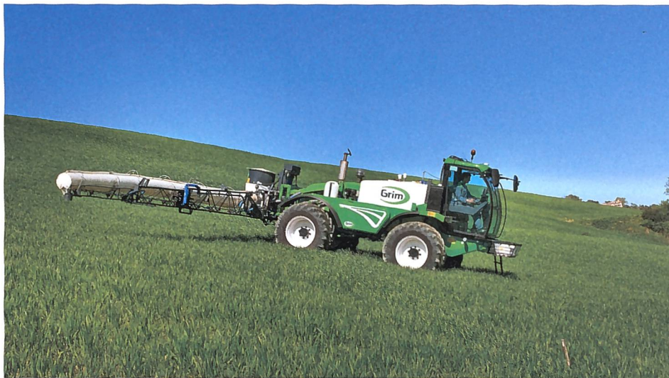
Die Hersteller sind bestrebt, eine gleichmässige Lastverteilung auf alle Räder zu erreichen. Der italienische Hersteller Grim bevorzugt die Variante Kabine-Tank-Motor.
