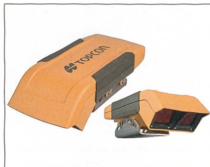
Der Sensor CropSpec von Topcon wird beidseitig auf dem Traktordach angebracht und arbeitet mit einem pulsierenden Laser, der das Chlorophyll der Pflanzen zum Leuchten anregt. (Foto: Werksfoto)
