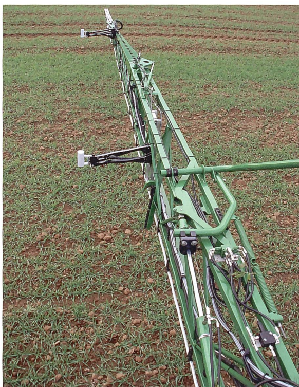
Der P3-Sensor am Spritzgestänge misst die Biomasse im Getreide mit Ultraschall. (Foto: Agri Con GmbH)
