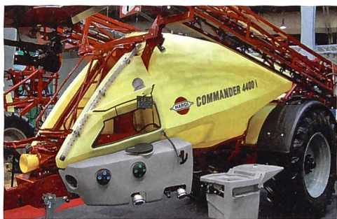
Für Armaturen und Bedienung haben gezogene Spritzen eine angenehme Arbeitshöhe.
