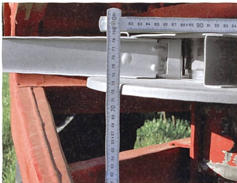
Die richtige Distanz der Streuscheibe ist mitentscheidend für die Arbeitsqualität. Dieses Mass kann der Betriebsanleitung entnommen werden.
