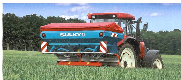
Wiegestreuer können zur automatischen Mengeneinstellung mit einem elektronischen und geschwindigkeitsabhängigen System ausgebaut werden.
