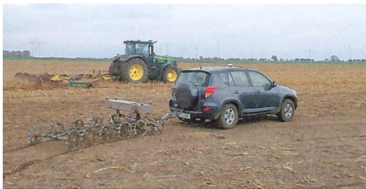
Der rollende Bodensensor «Geophilus» bei der Messfahrt auf einer Ackerfläche.
