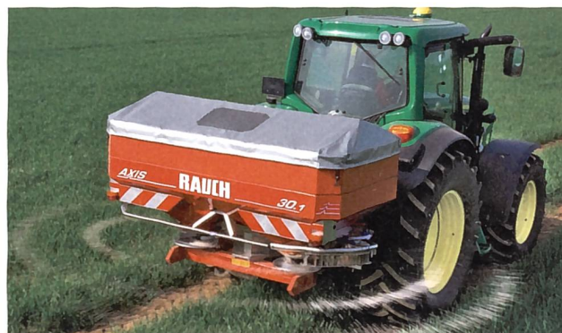
Bekannte Hersteller bauen die Düngerstreuer zunehmend mit GPS-Technologie aus. Zudem werden sie vermehrt Isobus-tauglich.
