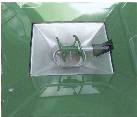
Horizontal arbeitende Rührwerke werden unabhängig von der Streuscheibe angetrieben. Sie drehen langsam und schonen die Düngerkornstruktur.
