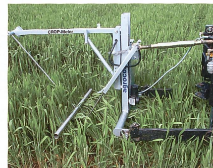
Das am ATB Potsdam entwickelte Crop-Meter ermittelt über den Biege widerstand der Pflanzenhalme die Biomasse des Bestandes. (Foto: ATB Potsdam/Gebbers)
