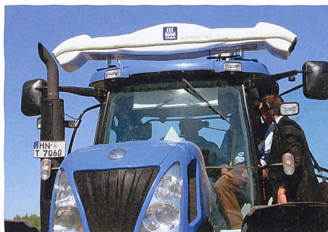
Die Stickstoffsensoren von Yara messen schräg vom Traktordach und erfassen so ein repräsentatives Messfeld. (Foto: Agri Con GmbH)
