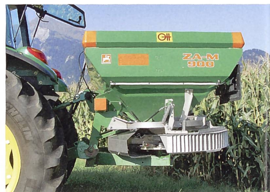
Feldgrenzen sind Problemzonen. Dieses Grenzstreusystem lenkt den Düngerstrom «in geordnete Bahnen» und setzt damit eine Streugrenze.
