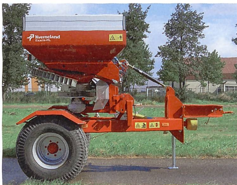
Hohe Ladevolumen erfordern zunehmend grosse Traktoren. Einfache Fahrwerke entschärfen dieses Problem und machen den Düngerstreuer zur Anhängemaschine für kleinere Traktoren.
