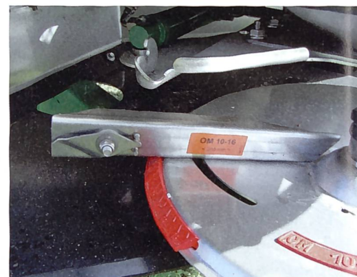
Streuschaufeln können zum Teil in Länge und Winkel den unterschiedlichen Anforderungen verschiedener Dünger angepasst werden.
