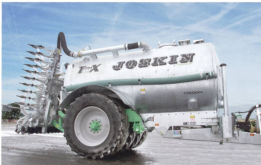
Beim TetraX Modulo von Joskin drehen die 4 Räder eigenständig um ihre Achse. (Bild: Werkbild)
