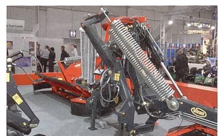
• **Kverneland (Vicon, Deutz-Fahr)** Bei Überlastung scheren auf Antriebswelle/Zahnrad zwei Passfedern ab. Damit kann die betroffene Mähscheibe stillstehen, und die weiteren Teile des Antriebsstranges werden nicht beschädigt. Die mittig gezogene Aufhängung ermöglicht zudem beim Auffahren auf ein Hindernis ein Ausweichen der Mäheinheit nach hinten und oben.
