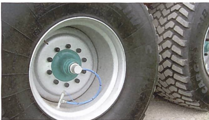
Wenn schon mehr Effizienz gefragt ist, dann brauchen Traktoren und schwere Anhänger Reifendruckregelanlagen.
