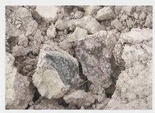
Kantige Klumpen und Fragmente lassen auf einen verdichteten Boden schliessen, der zudem unter (zu) feuchten Bedingungen bearbeitet wurde.
