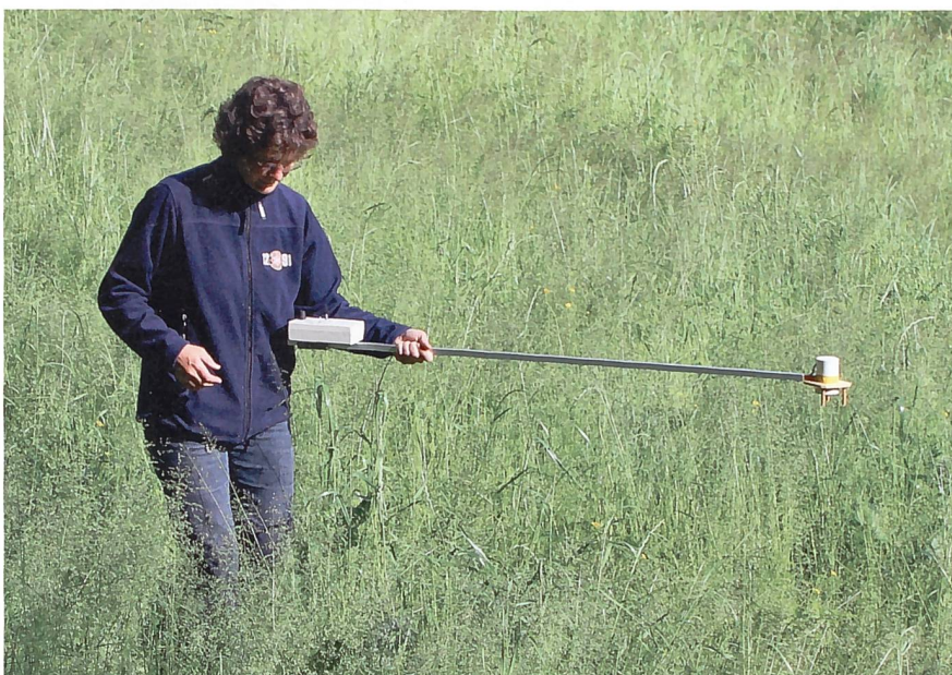
Abbildung 6: Infrarotsensor HAFL zum Aufspüren von Rehkitzen im hohen Gras, wenn die Standorte ungefähr bekannt sind. (Quelle Walter Berger)
