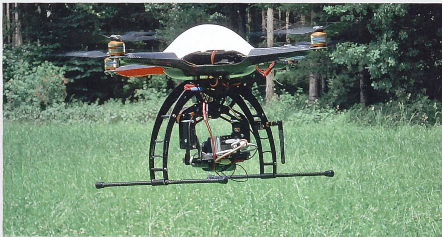
Abbildung 3: Quadrokopter mit zweiachsigem Kameragestell und Thermalkamera beim Einsatz für die Rehkitzsuche. (Quelle Nicole Berger)
