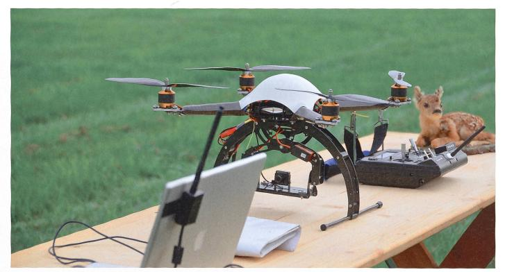
Computer, Multikopter, Wärmebildkamera, Fernbedienung samt kleinem Bildschirm (nicht auf dem Bild) gehören zur Ausrüstung, um Rehkitze in hohen Grasbeständen einfach zu finden. (Quelle: IGP ETHZ, UAVg-2011)
