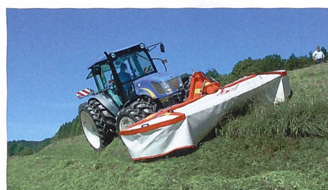
Bei der Polytrac-Hydraulik kann sich das Mäherwerk in Fahrtrichtung optimal neigen.
