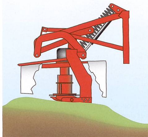
Die Frontmähwerke Splendimo F/FC von Lely sind wie die gezogenen aufgehängt und können bei einer Kollision nach oben ausweichen.
