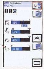
Der Entlastungsdruck kann am Traktorterminal jederzeit verstellt werden.
