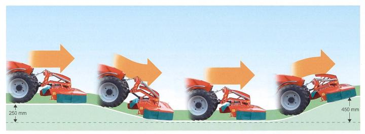
Bei Frontmähwerken mit Lenkeraufhängung (im Bild Active Lift) bleibt das Traktorhubwerk bei Bodenwellen in der gleichen Position.
