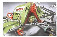
Hier sind die Entlastungszylinder zwischen Traktor und Mäher montiert.
