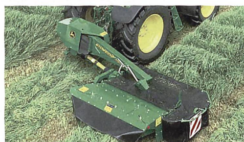
John Deere setzt bei den Heckmäherwerken auf hydraulische Entlastungen.
