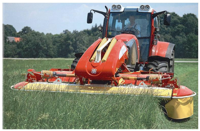
Die Lenker-gesteuerte Entlastung «alpha-motion» von Pöttinger arbeitet mit zwei langen Stahlfedern (Bilder: zVg)
