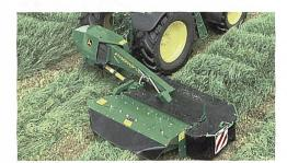
John Deere setzt bei den Heckmähwerken auf hydraulische Entlastungen.
