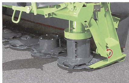
Die Frontscheibenmäher von Claas haben einen Drehpunkt (rot) nahe am Mähbalken.
