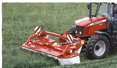
Dieses Frontmäherwerk von Kuhn ist mit einer gezogenen Aufhängung ausgestattet.
