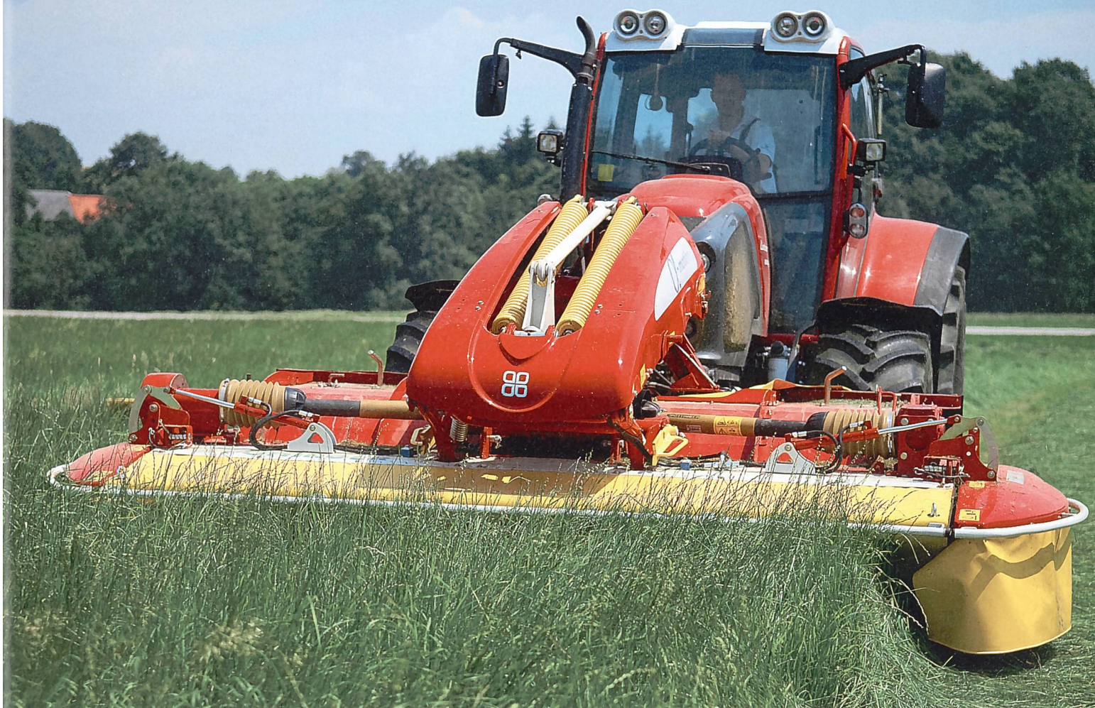
Die Lenker-gesteuerte Entlastung «alpha-motion» von Pöttinger arbeitet mit zwei langen Stahlfedern (Bilder: zVg)
