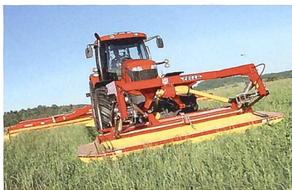
Mit Zugbock (im Bild Fella) ist ein Frontmähwerk wie ein gezogenes aufgehängt.
