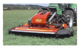
Vicon/Kverneland hat die Federn für mehr Stabilität nach aussen versetzt.
