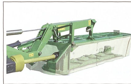
Beim DuoGrip von Krone werden seitliche Kräfte von Lenkern aufgenommen.
