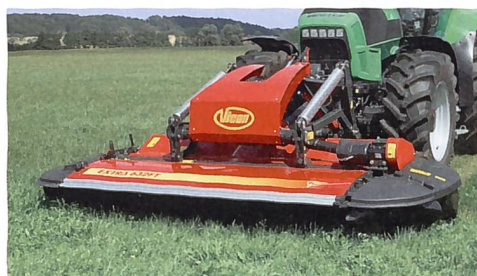
Vicon/Kverneland hat die Federn für mehr Stabilität nach aussen versetzt.
