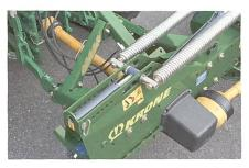
Bei diesem Mähwerk von Krone lässt sich die Federspannung hydraulisch verstellen.
