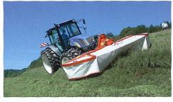
Bei der Polytrac-Hydraulik kann sich das Mähwerk in Fahrtrichtung optimal neigen.
