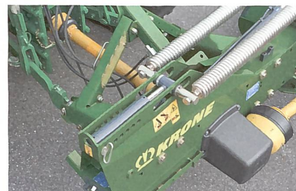
Bei diesem Mähwerk von Krone lässt sich die Federspannung hydraulisch verstellen.
