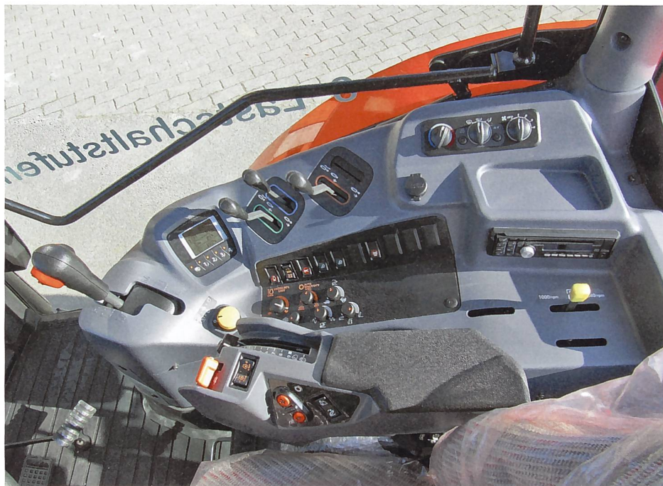
Informationsdisplay und ergonomische Anordnung der Bedienelemente auf der rechten Kabinenseite.
