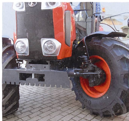
Die spezielle Technik des Kegelradantriebs sorgt für einen extremen Lenkeinschlag.
