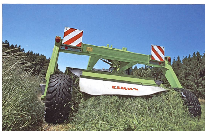
Die Ablagebreite des Mähschwads ist mittels Leitblechen einstellbar. (Bild: Ruedi Hunger)
