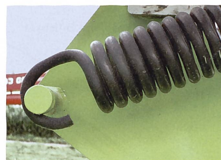
Die Mäheinheiten sind pendelnd aufgehängt und werden vielfach mittels einstellbarer Federn sanft über den Boden geführt.
