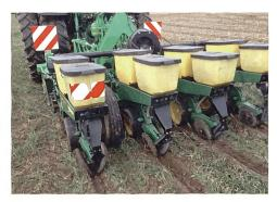
Die Saateinheiten stammen von einer John-Deere-Direktsaatmaschine.
