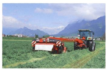
... Im Gegensatz dazu kann ein Mähwerk mit mittiger Deichselanlenkung links oder rechts vom Traktor gefahren werden. (Bild: Ruedi Hunger)
