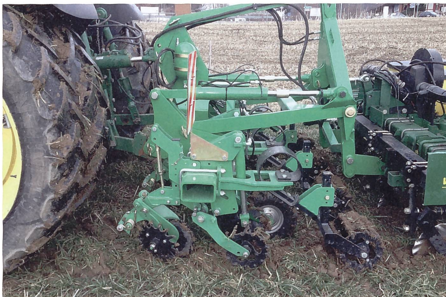
Das Grubberschar lockert den Boden auf, ohne Erde nach oben zu reissen.
