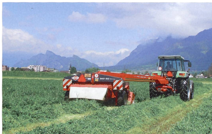
... Im Gegensatz dazu kann ein Mähwerk mit mittlerer Deichselanlenkung links oder rechts vom Traktor gefahren werden. (Bild: Ruedi Hunger)
