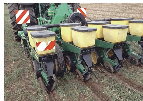
Die Saateinheiten stammen von einer John-Deere-Direktsaatmaschine.
