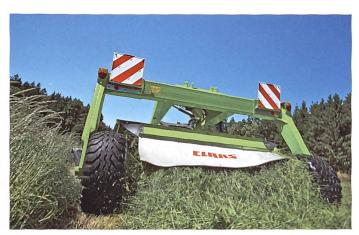
Die Ablagebreite des Mähschwads ist mittels Leitblechen einstellbar. (Bild: Ruedi Hunger)
