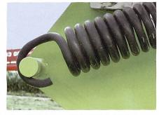
Die Mäheinheiten sind pendelnd aufgehängt und werden vielfach mittels einstellbarer Federn sanft über den Boden geführt.
