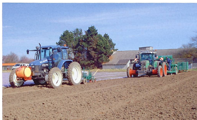
Abb. 1, oben: israelische Field Power Unit (FPU) mit 5,80 m Arbeitsbreite und um 90 ° schwenkbaren Rädern. Im Feld wird in Quer- und auf der Strasse in Längsrichtung gefahren. Unten: Traktoren mit verbreiterter Spur im holländischen Gemüsebau. Quelle: Chamen, Pedersen
