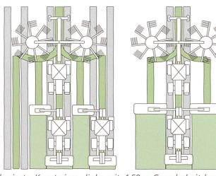
Abb. 6: Traktorbasierte Kunstwiese, links mit 4,50 m Grundarbeitsbreite liegt der Spurflächenanteil bei etwa 27 %. Rechts mit 9 m sinkt der Spurflächenanteil auf 13 %.
