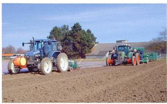
Abb. 1, oben: israelische Field Power Unit (FPU) mit 5,80m Arbeitsbreite und um 90° schwenkbaren Rädern. Im Feld wird in Quer- und auf der Strasse in Längsrichtung gefahren. Unten: Traktoren mit verbreiterter Spur im holländischen Gemüsebau. Quelle: Chamen, Pedersen
