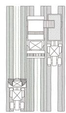
Abb. 10: Sechsreihiges Rübenanbausystem mit Köpfrodelader. Bei 3 m Arbeitsbreite liegt der Spurflächenanteil bei etwa 65%.
