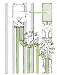
Abb. 7: Kunstwiese mit Häcksler. Das Futter wird mit einem Seitenschwader in der Häckslerfahrspur abgelegt.
