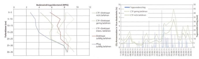
Abb. 2, links: Bereits nach zwei Jahren hatte CTF nicht befahren nach Pflug den niedrigsten Bodeneindringwiderstand entwickelt. Rechts: Bei geringer Befahrung ist der CO<sub>2</sub>-Gehalt unter feuchten Bedingungen um 2,5–4% höher als in nicht befahren.
