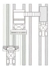
Abb. 11: Skizze eines neunreihigen Rübenanbausystems mit 4,50 m Arbeitsbreite und einem Spurflächenanteil von zirka 27%. Der selbstfahrende Köpfrodelader müsste über 5,40 m überladen.
